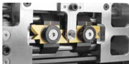
Зачищающий нож, который можно использовать с обеих сторон для поддержания неизменно высокого качества
