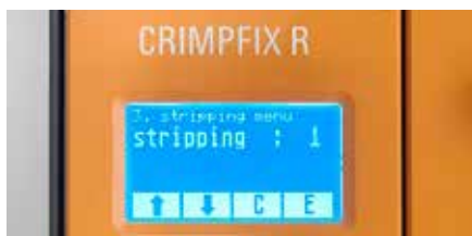
Отдельный настраиваемый режим зачистки
