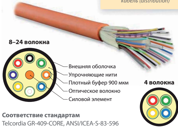
Обычный распределительный кабель (distribution)
