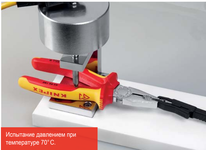
Проверка надежности соединения электроизолированных чехлов с ручками инструмента под нагрузкой 500 Н.
