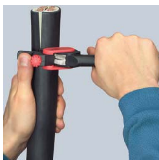
Вращение инструмента для разреза по окружности
