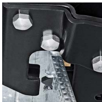
Пуансон инструмента продавливается через профили
