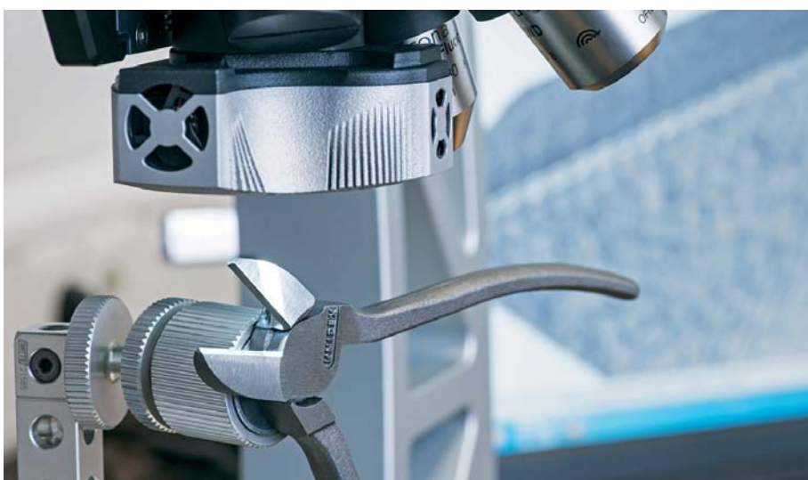
Форма и микрошероховатость лезвий в боковых кусачках точно измеряются с помощью оптической 3D системы.
