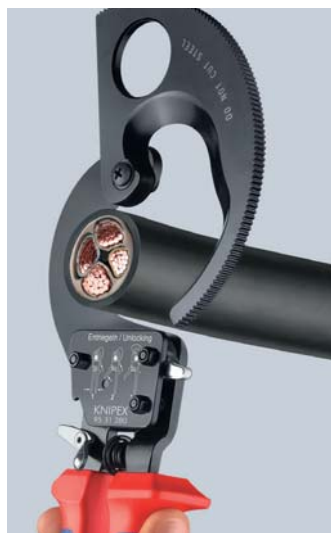
95 31 280: увеличенный разворот: до Ø 52 мм / 380 мм 2
