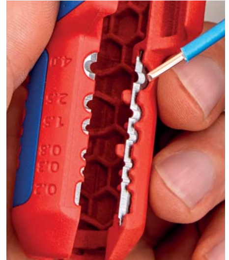
Удаление изоляции с отдельных проводов
