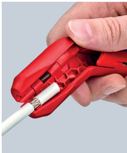
Удаление оболочки с коаксиального кабеля
