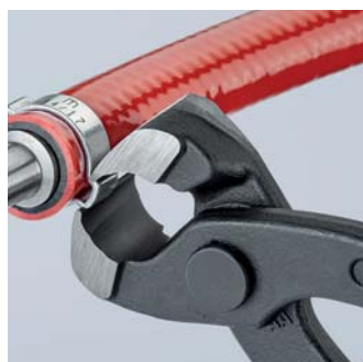
Герметичное крепление хомутом гибкого шланга на штуцере
