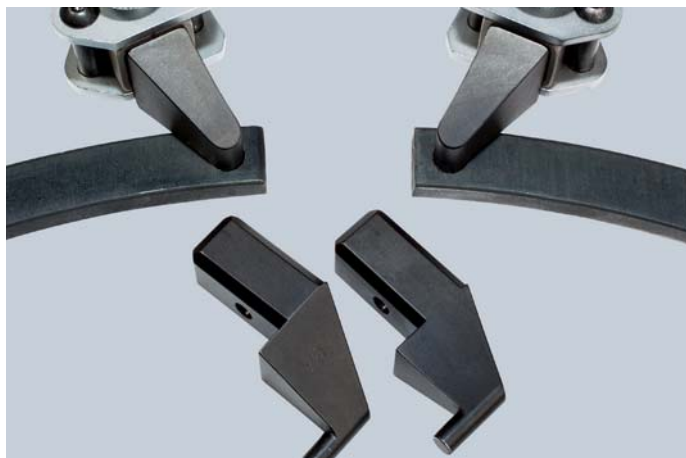
Сменные вставки для наружных и внутренних колец
