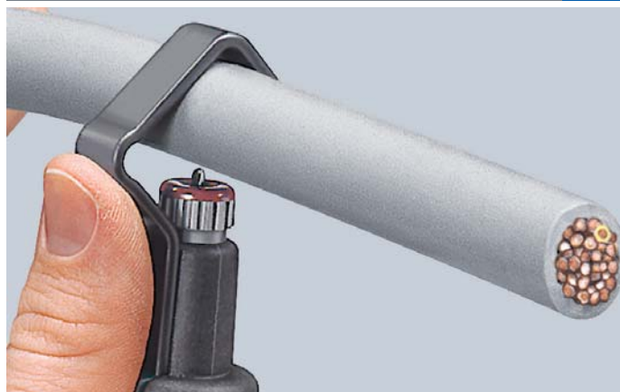
Установка инструмента для разреза по окружности
