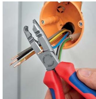
Укорачивание отдельных проводов
