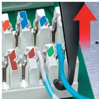
Со встроенным крючком для вытягивания
