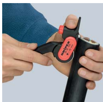
Установка инструмента для продольного реза
