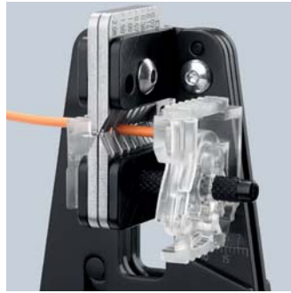
Ровное надрезание изоляции по всей окружности кабеля
