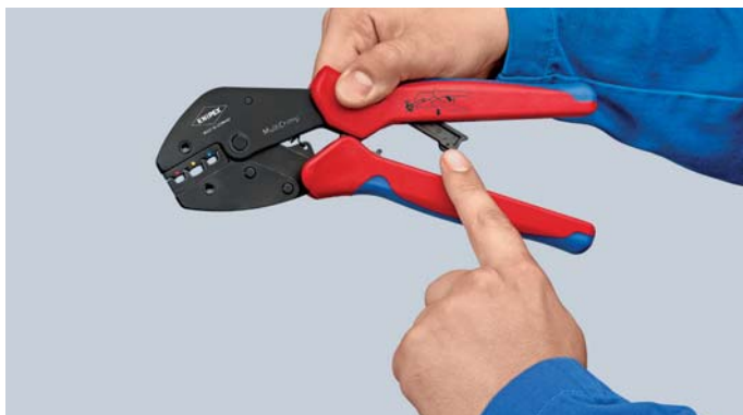
Задвиньте вспомогательный рычаг и сожмите клещи до отказа – устройство готово к применению
