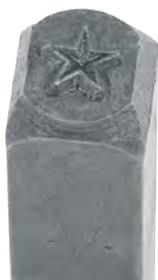
Die Handschlagstempel mit Stern der Baureihe 300 werden zur problemlosen Kennzeichnung von Werkstücken mit einer Festigkeit von bis zu 900 N/mm<sup>2</sup> (27 HRC) in Handwerk, Industrie und Werkstatt genutzt. Die Stempel besitzen eine Härte an der Gravur zwischen 58 und 61 HRC. Die Stempel sind insbesondere für die Begrenzung von Texten und Seriennummern auf Typenschildern geeignet.
