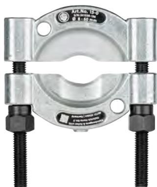
Die Trennvorrichtungen der Baureihe 15 werden gemeinsam mit den Abziehvorrichtungen der Baureihe 18 zum Abziehen von Kugellagern, Rollenlagern, Innenringen und anderen plan aufliegenden Teilen in Handwerk, Industrie und Werkstatt genutzt, wenn für Abzugshaken nicht ausreichend Platz vorhanden ist. Der Trenn-Abzieh-Prozess ist dazu in der Lage, jene Teile zunächst schonend zu trennen, bevor sie von außen abgezogen werden können.
