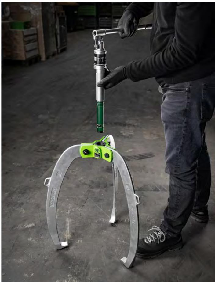
Einsetzen der fetthydraulischen Spindel
