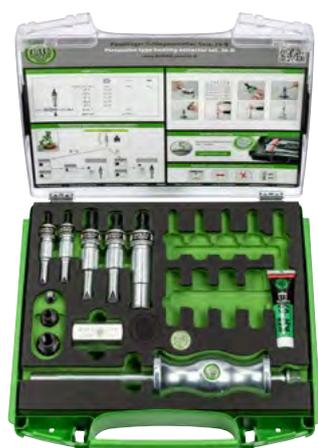
Der 10-teilige Innenauszieh-Satz für Schlagbetätigung 26-B wird zum Ausziehen innenliegender Lager, Lageraußenringe und Buchsen in Handwerk, Werkstatt und Industrie eingesetzt. Die 2-schalige Ausführung der Innenauszieher mit ihren extra großen Greifkanten erlaubt das sichere Ausziehen innenliegender Teile. Der beigelegte Gleithammer wird gemeinsam mit den Innenausziehern genutzt.
