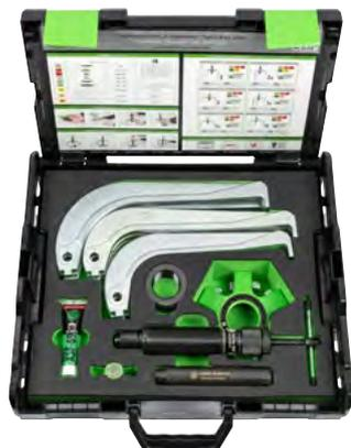
Der 15-teilige, hydraulische „6 Abzieher“-Satz mit selbstzentrierenden Abzugshaken wird zum Abziehen von Lagern, Zahnrädern, Scheiben etc. in Handwerk, Industrie und Werkstatt genutzt. Im Set enthalten sind Abzieher, Hydraulikspindel, Haken, sowie 2- und 3-armige Kombi-Traversen, die durch die leicht austauschbaren, vielfach kombinierbaren Einzelteilen zu sechs verschiedenen Abziehern kombiniert werden können.
