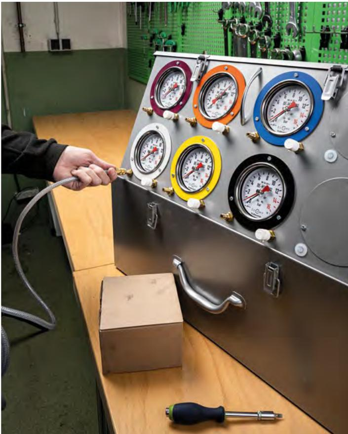
Verbinden eines Pneumatikschlauchs mit dem Kupplungsstecker
