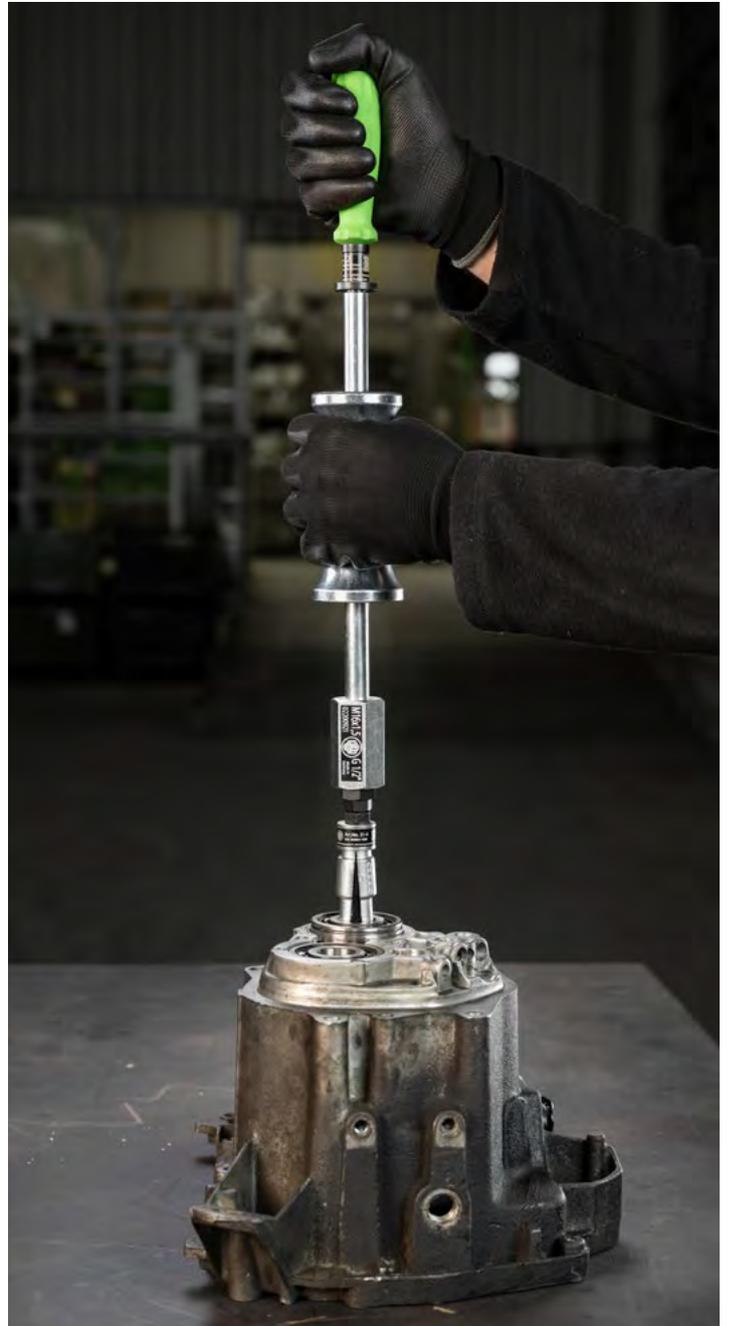
Innenausziehen eines Kugellagers mit dem 21-4 und einem Gleithammer
