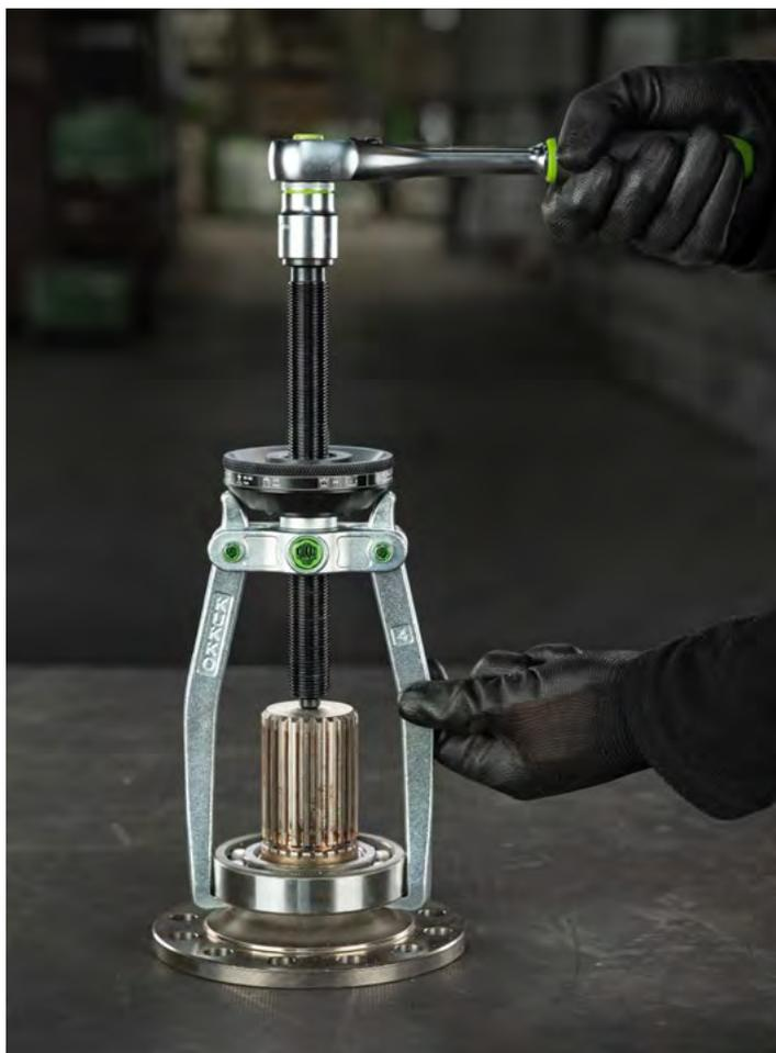
Außenabziehen eines Kugellagers von einer Antriebswelle
