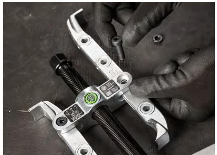
Durch das Umdrehen der Abziehschenkel können passend zur Anwendung die Klauen gewechselt werden.
