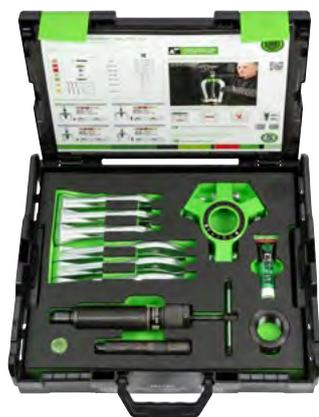
Der 11-teilige, hydraulische „4 Abzieher“-Satz mit selbstzentrierenden Abzugshaken wird zum Abziehen von Lagern, Zahnrädern, Scheiben etc. in Handwerk, Industrie und Werkstatt genutzt. Im Set enthalten sind Abzieher, Hydraulikspindel, Haken, sowie 2- und 3-armige Kombi-Traversen, die durch die leicht austauschbaren, vielfach kombinierbaren Einzelteilen zu vier verschiedenen Abziehern kombiniert werden können.
