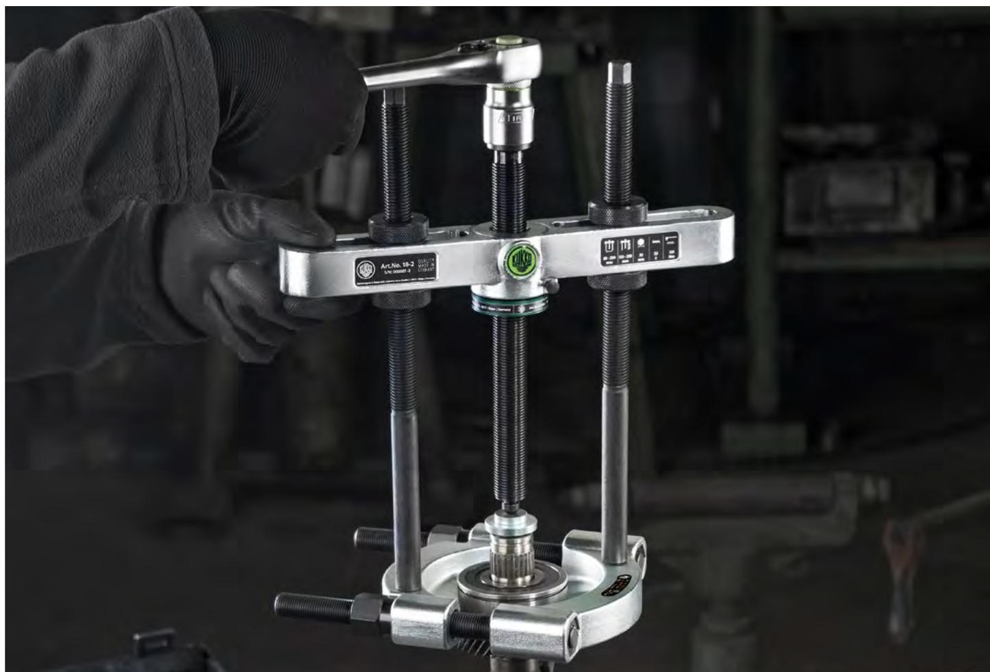
Die Trennvorrichtung 15-2 beim Abziehen eines festsitzenden Zahnrads an einem Maschinenbauteil
