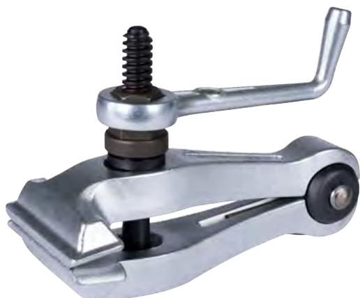
Die Handfeilkloben für Installateure mit breitem Maul, Sechskantmutter und Schlüssel der Baureihe 107 werden zum Spannen von Werkstücken bei Arbeiten von Installateuren und Klempnern genutzt. Die Backeninnenseite ist dabei mit einem prismatischen Einschnitt geriffelt, sodass runde und kantige Teile gespannt werden können. Die Baureihe 107 überzeugt durch ihre Handlichkeit, die ein Drehen und Wenden des Werkstücks beim Arbeiten ermöglicht.
