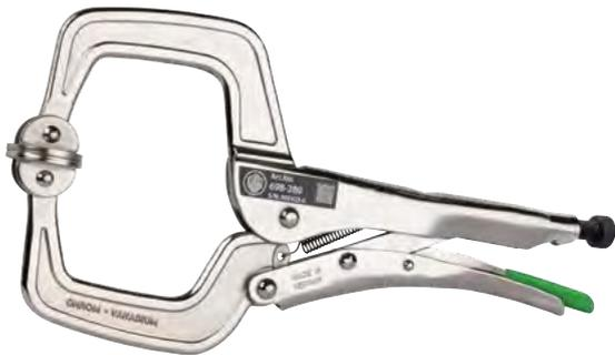
Die Parallel-Klammer-Gripzangen der Baureihe 698 werden zum Spannen und Klemmen von Rund-, Profil- und Flachmaterial in Werkstatt, Industrie und Handwerk genutzt. Die Gripzangen sind nicht nur handlich und können einhändig bedient werden, durch die Kniehebel-Mechanik lassen sich zudem sehr hohe Kräfte aufbringen. Die Baureihe 698 mit ihren beweglichen Backen mit großen Auflagetellern bewirkt eine hervorragende Klemmwirkung auch bei unsymmetrischem Material.
