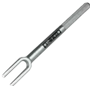
Die Trenngabeln der Baureihe 135 werden zum Lösen von im Konussitz festgekeilten Kugelbolzengelenken, beim Lösen von Lenkstockhebeln, bei der Demontage von Stoßdämpfern und bei sonstigen Trennarbeiten aller Art in Automotive und Industrie genutzt. Ihre universelle Einsetzbarkeit macht die Trenngabeln zu einem wichtigen Begleiter bei Demontage- und Trennarbeiten.
