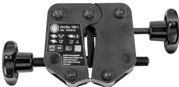
Die Keilzieh-Zange für Keile in Nuten wird zum leichten und beschädigungsfreien Ausziehen von festsitzenden Keilen aus den Keilnuten von Wellen in Handwerk, Industrie und Werkstatt genutzt. Mit der Zange ist es möglich, selbst stark befestigte Keile aus Keilnuten von Antriebswellen zu lösen. Die Baureihe 139 überzeugt durch ihre Kompaktheit und einfache Anwendungsweise. Sie ist in ihrer Konstruktion ideal für die Nutzung an Elektromotoren geeignet.
