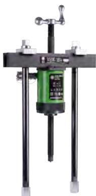
Die hydraulische Abziehvorrichtung der Baureihe Y-180 wird zum Abziehen von besonders großen und festsitzenden Lagern, Zahnrädern, Scheiben, etc. durch Einsatz mit Trennmessern und Innenausziehern in Handwerk, Werkstatt und Industrie eingesetzt. Die Baureihe Y-180 wird gemeinsam mit der Trennvorrichtung Y-15 oder dem Innenauszieher Y-21-E verwendet und ist auf diese Weise auf zweierlei Art einsetzbar.
