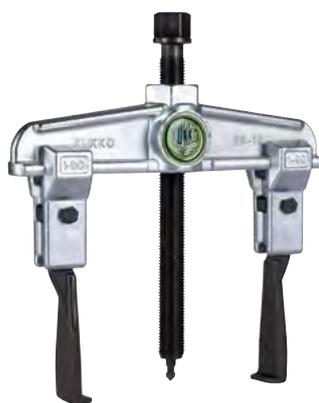
Der 2-armige Universal-Abzieher mit extrem schmalen Abzugshaken und trapezförmiger Auflagefläche an der Klaue wird zum sicheren Abziehen von Getriebezahnrädern, Lagern, Ritzeln, Synchronkörpern sowie ähnlichen Bauteilen eingesetzt. Damit lässt sich jedes Bauteil lösen, das auf einer Welle sitzt und von außen frei zugänglich ist. Die besondere Bauform der Abzugshaken sorgt dafür, dass auch sehr enge und schlecht zugängliche Zwischenräume erreicht werden.
