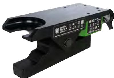
Der Spur- und Schubstangengelenk-Abzieher mit hydraulischem Hubzylinder der Baureihe 129 wird zum hydraulischen Ausdrücken der Kugelzapfen beim Ausbau von Kugelgelenken an Schub- und Spurstangen speziell für LKW und Niederflrbusse genutzt. Diese extra schwere Ausführung ist besonders zum hydraulischen Ausdrücken bzw. zum Trennen der Kugelgelenke an den Spur- und Schubstangen geeignet.
