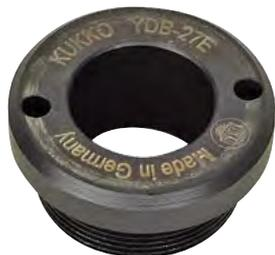
Die Druckstücke für Hohlkolbenzylinder werden in das Innengewinde der Kolbenstange von Hohlkolbenzylinder eingeschraubt. Die Mittelspindel kann direkt in das Gewindestück eingesetzt, oder bei Verwendung eines Druckstückes mit glatter Bohrung mittels Schnellverstellmutter befestigt und verstellt werden. Bei Verwendung des geschlossenen Druckstückes können die Zylinder als Hebeböcke eingesetzt werden.
