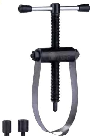
Die Kolbenbolzen-Drücker der Baureihe 102 werden zum schonenden Ein- und Ausdrücken der Kolbenbolzen in der Automotive genutzt. Das Werkzeug ermöglicht eine sichere Montage und Demontage von Kolbenbolzen per Druckstücke, ohne dass der Kolben dabei beschädigt wird. Artikel 102-0 enthält zwei zusätzliche Druckstücke, 102-1 ist für große Kolbenringdurchmesser ausgelegt und enthält drei zusätzliche Druckstücke.
