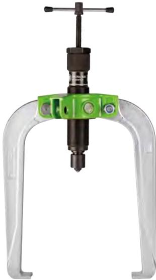
Die fetthydraulische Spindel der Baureihe 800 ist der Motor des Abziehers und erreicht eine Zugkraft von 10 t. Die Spindel ist an den Seiten geriffelt, um für die Finger beim Nachsetzen einen besonders guten Halt zu bieten.
