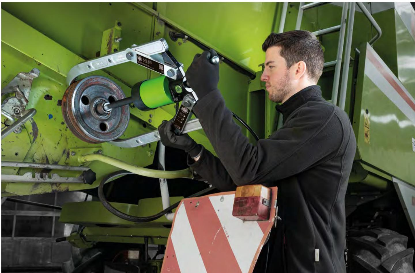
Außenabziehen einer Riemscheibe an einem Mähdrescher mit dem hydraulischen Abzieher Y28-205
