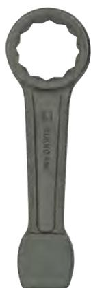
Die Schlag-Ringschlüssel (DIN 7444) der Baureihe 406 werden für die Anwendungsbereiche NFZ, Rohrindustrie, Tankreinigung, petrochemische Industrie, Stahl- und Bergbau usw. verwendet. Diese rutschen nicht so leicht ab wie Maulschlüssel und erlauben eine höhere Kraftübertragung, jedoch wird ein offener Zugang zur Schraube benötigt. Die Baureihe 406 zeichnet sich durch ihre Ausführungsvielfalt aus. Zahlreiche Größen ermöglichen den Einsatz bei verschiedenen Schraubengrößen.
