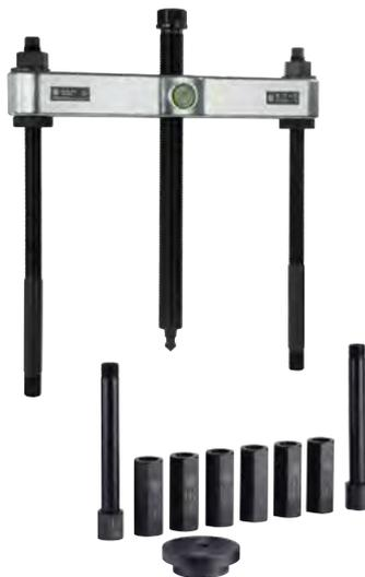
Die Abziehvorrichtung für LKW-Achsen der Baureihe 226 wird zum Abziehen von Radnaben an SAF und BPW Achsen für LKW und NFZ in der Automotive genutzt. Neben der Abziehvorrichtung sind zudem mehrere Adapter enthalten, die die Anwendung an den meisten gängigen Modellen ermöglichen.
