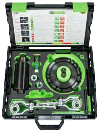
Der hydraulische Radnabenabzieher wird zum Abziehen von Radnaben an PKW und LKW eingesetzt. Die fetthydraulische Spindel erreicht eine Zugkraft von 20 t. Auf der Teilscheibe können bis zu sechs Abzugshaken eingesetzt werden, wodurch der Abzieher universell einsetzbar ist. Zudem können die Abzugshaken auf zwei verschiedene Längen eingestellt werden.
