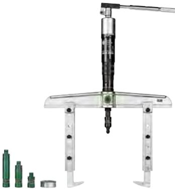
Der 2-armige Universal-Abzieher mit Hydraulikspindel eignet sich zum Abziehen von besonders festsitzenden Lagern, Zahnrädern und Scheiben mit einer Abziehkraft von bis zu 20 t. Dank integrierter Fetthydraulik ist keine externe Pumpe erforderlich. Der manuell verlängerbare Hebelarm kann um 360° geschwenkt werden. Das flexible Anschlussgewinde an der Spindel ermöglicht je nach Gewindegröße die Montage zahlreicher Abziehwerkzeuge aus dem KUKKO Sortiment.
