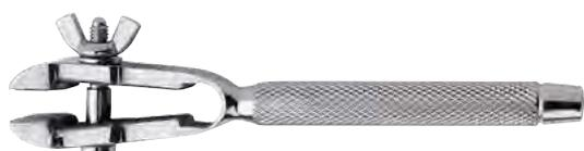
Die Stielfeilkloben mit feinem Maul der Baureihe 113 werden zum Spannen von besonders feinen Werkstücken in Werkstatt, Industrie und Handwerk genutzt. Die Backeninnenseite ist dabei mit einem prismatischen Einschnitt geriffelt, sodass runde und kantige Teile gespannt werden können. Die Baureihe 113 eignet sich dabei vor allem für Feinarbeiten z.B. an Uhren und ermöglicht eine filigrane und präzise Arbeitsweise.
