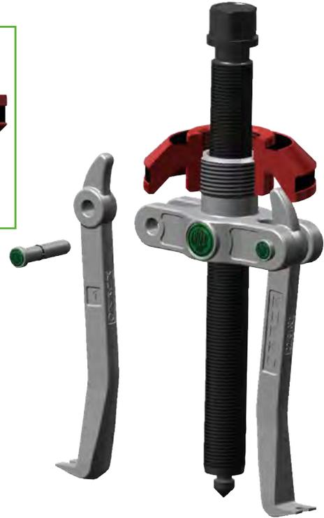
Der Spannkonus wird um 180° gedreht. Durch Lösen der Bolzen können die Schenkel herausgenommen und umgekehrt werden.
