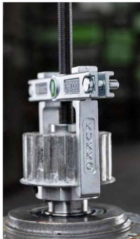
Sicherungsstift ist eingesetzt worden
