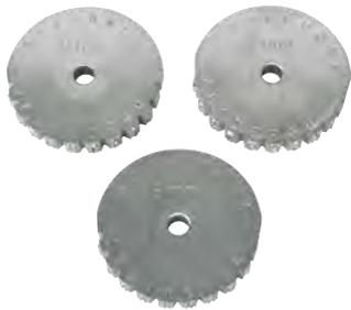
Der Radschlagstempel für Buchstaben der Baureihe 332 wird gemeinsam mit einem Stempelhalter zum problemlosen Kennzeichnen von Zahlenreihen in Werkstücken mit einer Festigkeit von bis zu 1300 N/mm<sup>2</sup> in Handwerk, Industrie und Werkstatt genutzt. Der Satz besitzt eine Härte an der Gravur zwischen 58 und 61 HRC. Die Radschlagstempel der Baureihe 332 sind durch ihre vernickelte Oberfläche besonders für das Kennzeichnen von Edelstahl geeignet.
