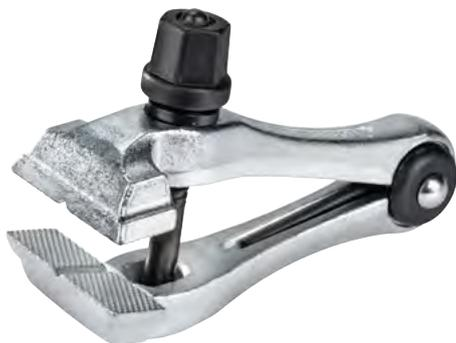
Die Handfeilkloben mit breitem Maul und Sechskantmutter der Baureihe 101 werden zum flächigen Spannen von Werkstücken in Werkstatt, Industrie und Handwerk genutzt. Die Backeninnenseite ist dabei mit einem prismatischen Einschnitt geriffelt, sodass runde und kantige Teile gespannt werden können. Die Baureihe 101 überzeugt durch ihre Handlichkeit, die ein Drehen und Wenden des Werkstücks beim Arbeiten ermöglicht.
