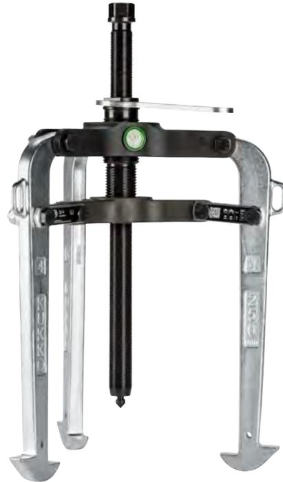
Der 3-armige Abzieher „Alligator“ mit voreinstellbaren Abziehschenkeln ist mit einer Hakenauflage an der Innen- und Außenseite ausgestattet. Dies macht ihn universell einsetzbar als Außenabzieher sowie Innenauszieher.
