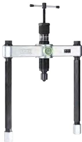
Die Ausziehvorrichtung mit hydraulischer Spindel wird für eine universelle Anwendung mit den Abziehern der Baureihe 818 in Handwerk, Werkstatt und Industrie eingesetzt. Die Modellreihe ist im Baukastensystem aufgebaut und dadurch vielfältig erweiterbar. Diese Abziehvorrichtung ist das Grundelement eines Systems, das in Verbindung mit verschiedenen Zubehörteilen, wie z.B. Innenauszieher, Abzugshaken oder Trennvorrichtungen, universelle Anwendungsmöglichkeiten gestattet.
