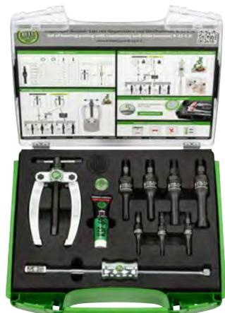
Der 9-teilige Kugellager-Auszieh-Satz mit Gegenstütze und Gleithammer K-22-C-E wird zum Ausziehen plan aufliegender Lager, Lageraußenringe und Buchsen in Handwerk, Werkstatt und Industrie eingesetzt. Die segmentierte Ausführung mit extra feinen Greifkanten erlaubt das sichere Ausziehen plan aufliegender Teile. Die beigelegte Gegenstütze oder der Gleithammer werden je nachdem, ob eine ausreichende Abstützfläche vorhanden ist, gemeinsam mit den Innenausziehern genutzt.
