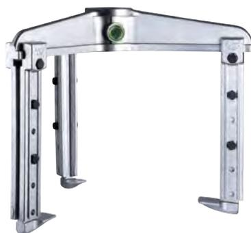
Die 3-armigen Abzieher mit verstellbarer Spanntiefe der Baureihe Y20-11 werden zum Abziehen von besonders großen und fest-sitzenden Lagern, Zahnrädern, Scheiben etc. in Handwerk, Industrie und Werkstatt genutzt. Die extra kräftige Ausführung ist dazu in der Lage, dank parallelen Abzugshaken in jeder Position und unter Vollbelastung Bauteile sicher und effizient abzuziehen. Zur Anwendung wird noch ein Hydraulischer Hohlkolbenzylinder der Baureihe YRH benötigt.
