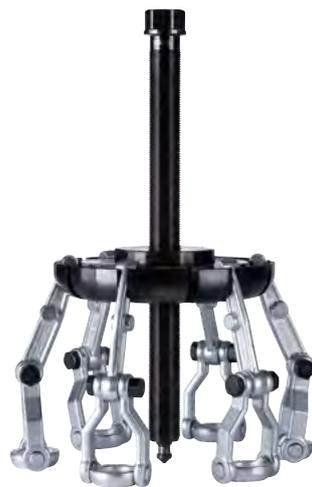
Der Radnabenabzieher mit Scheibentraverse wird zum Abziehen von Radnaben an LKW eingesetzt. Auf der Traverse können bis zu sechs Abzugshaken in unterschiedlichen Positionen eingehängt werden. Die Haken lassen sich zudem auf zwei verschiedene Längen einstellen. Dadurch ist der Abzieher auch bei variablen Lochkreisdurchmessern universell einsetzbar.
