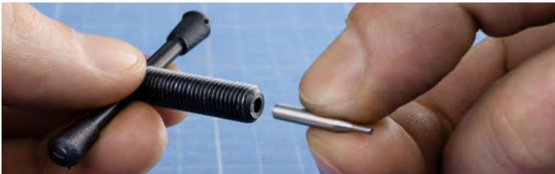
Die Spindelspitze des Micro-Abziehers ist per Magnet mit der Spindel verbunden und lässt sich daher mühelos austauschen. Einfach die Spindelspitze herausziehen und durch eine andere ersetzen. Diese Austauschmöglichkeit macht den Abzieher noch universeller einsetzbar.
