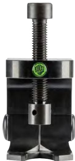
Die Universal-Scheibenwischer-Abzieher mit verstellbarer Spannweite der Baureihe 128-F-60 werden zum Abziehen festsitzender, eingerosteter und vertieft eingebauter Scheibenwischerarme in der Automotive genutzt. Der zurückschnellende Federmechanismus hält die Abzugshaken auf Spannung. Dank austauschbarer Haken kann der Abzieher auch bei tiefsitzenden Wischerarmen verwendet werden.
