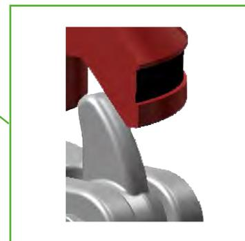
Detailansicht: Beim Innenausziehen werden die Abziehschenkel durch die Innenkontur des Spannkonus nach außen geführt.
