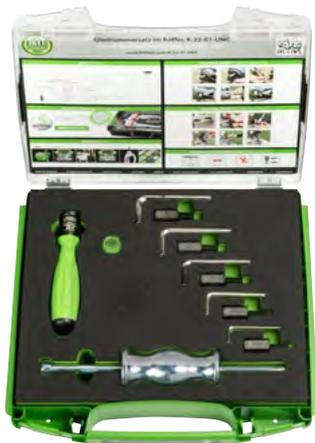
Der 12-teilige Gleithammersatz im Koffer K-22-01-UNC wird zum Ausziehen von Teilen mit Gewindelöchern (Passstifte, Passfedern, etc.) mit amerikanischen Gewindemaßen eingesetzt. Die im Satz enthaltenen Gewinde können mittels der ebenfalls inklusiven entsprechenden Inbuschlüssel eingedreht werden, um effektiv mit amerikanischen Gewindegrößen zu arbeiten. Der beigelegte Gleithammer wird gemeinsam mit Innenausziehern genutzt.
