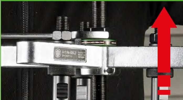
Die Power Nut befindet sich oberhalb der Traverse. Durch das Drehen an der Power Nut wird die Spindel mit verstärkter Kraft nach oben gezogen, bis die Zylinderbuchse ausgezogen ist.
