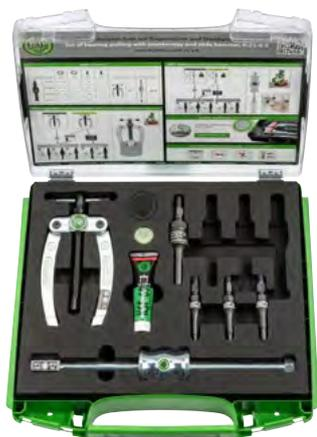
Der 6-teilige Kugellager-Auszieh-Satz mit Gegenstütze und Gleithammer K-22-A-E wird zum Ausziehen plan aufliegender Lager, Lageraußenringe und Buchsen in Handwerk, Werkstatt und Industrie eingesetzt. Die segmentierte Ausführung mit extra feinen Greifkanten erlaubt das sichere Ausziehen plan aufliegender Teile. Die beigelegte Gegenstütze oder der Gleithammer werden je nachdem, ob eine ausreichende Abstützfläche vorhanden ist, gemeinsam mit den Innenausziehern genutzt.
