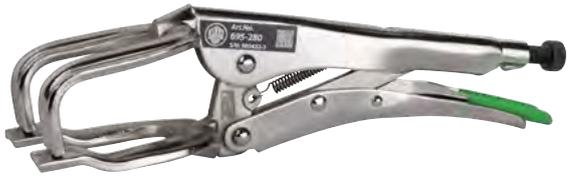
Die Schweißer-Gripzangen der Baureihe 695 werden zum zentrischen Spannen beim Verschweißen von Profil- oder Flachmaterial auf Stoß in Werkstatt, Industrie und Handwerk genutzt. Die Gripzangen sind nicht nur handlich und können einhändig bedient werden, durch die Kniehebel-Mechanik lassen sich zudem sehr hohe Kräfte aufbringen. Die Baureihe 695 mit ihren Greifbacken in U-Form ermöglicht durch ihre gute Vibrationsaufnahme ein leichteres und flexibleres Spannen.
