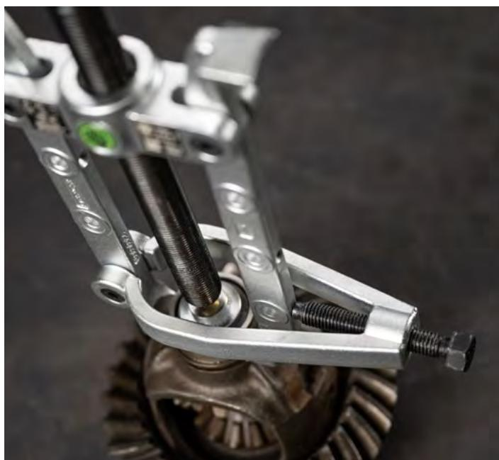
Die Spannzwinde presst die Abziehschenkel fest an das abziehende Bauteil
