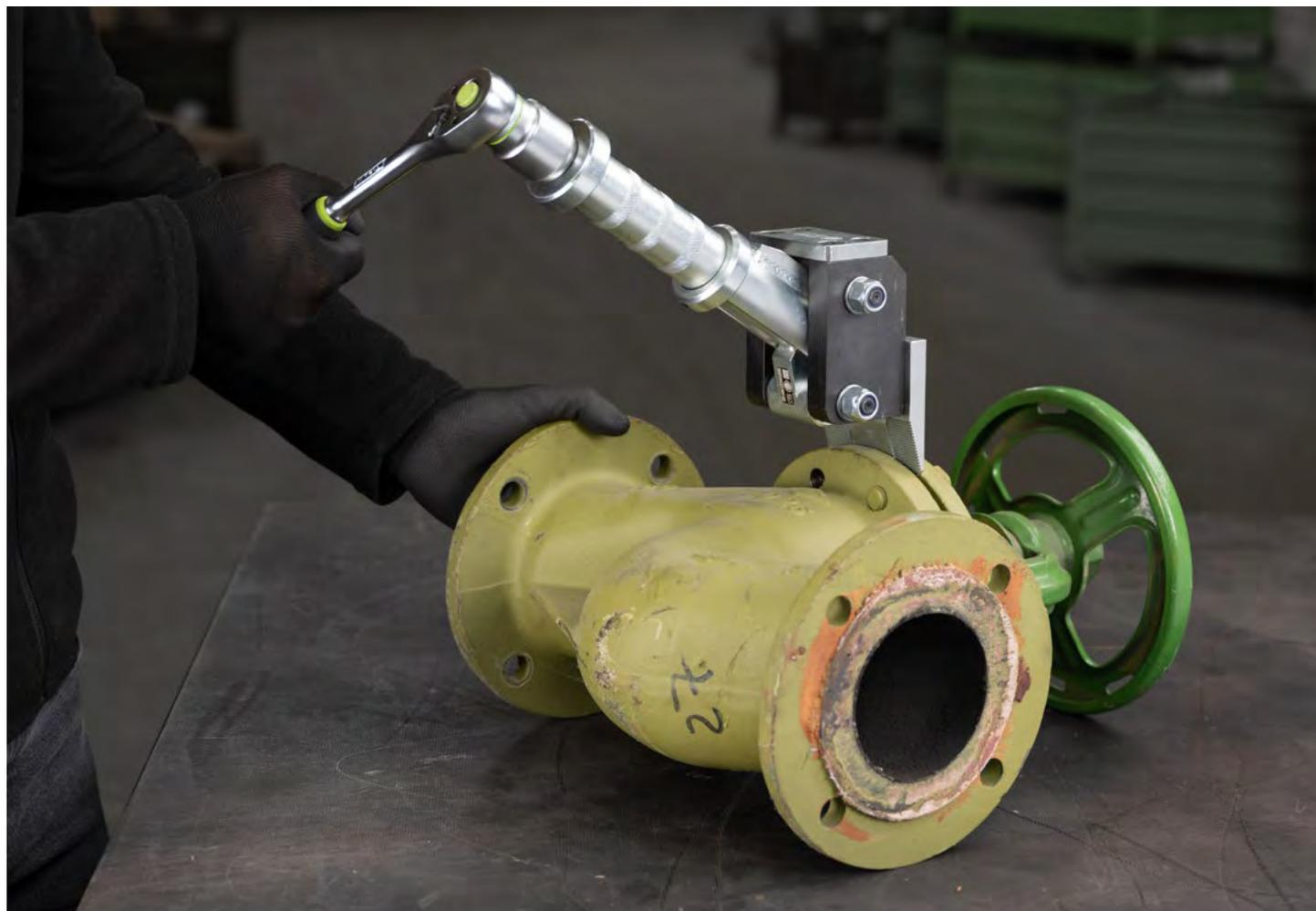
Ein Universal-Spreizer der Baureihe 165 beim Spreizen einer Flanschverbindung an einem Absperrventil
