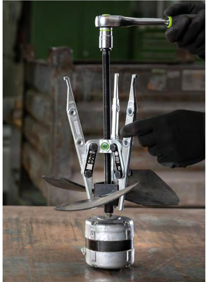
Durch eine 180° Drehung der Abziehschenkel kann mit einer anderen Klauengröße abgezogen werden.
