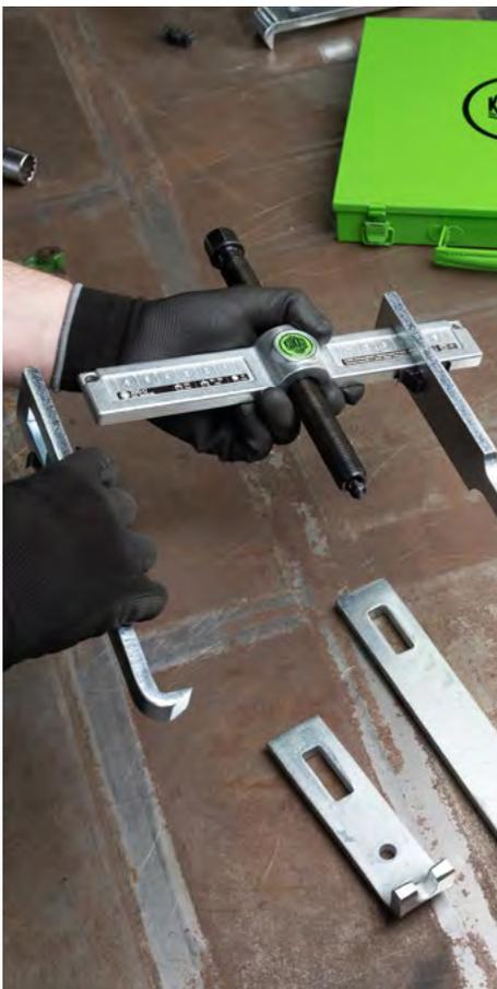
Die Abziehschenkel werden auf die Traverse gesetzt; eine Skala auf der Traverse erleichtert das korrekte Einstellen der Abstände
