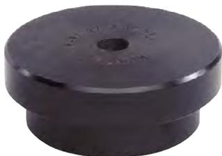
Die Druckstücksätze für Achsbohrungen werden zum Abziehen von Lagern und Zahnrädern in Handwerk, Industrie und Werkstatt genutzt, die auf Hohlwellen oder in Gehäusen gelagert sind. Das Spindeldruckstück dient als Gegenachse zum Abzieher, indem die Spindel die Kraft auf das Druckstück überträgt.
