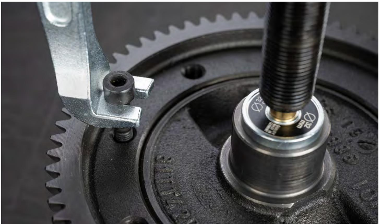
Durch den Schlitz im Haken können Bauteile mit Hilfe einer Schraube abgezogen werden
