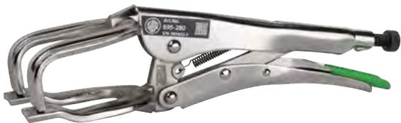
Die Rohrschweißer-Gripzangen der Baureihe 696 werden zum zentrischen Spannen beim Verschweißen von Rund- oder Rohrmaterial auf Stoß in Werkstatt, Industrie und Handwerk genutzt. Die Gripzangen sind nicht nur handlich und können einhändig bedient werden, durch die Kniehebel-Mechanik lassen sich zudem sehr hohe Kräfte aufbringen. Die Baureihe 696 ermöglicht durch ihre gute Vibrationsaufnahme ein leichteres und flexibleres Spannen auch bei runden Materialien.
