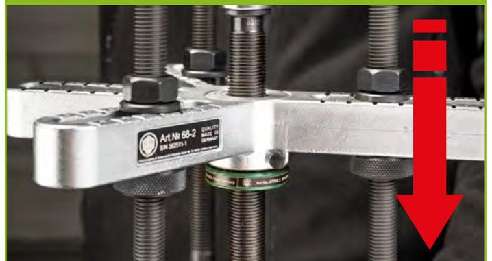
Die Power Nut befindet sich unterhalb der Traverse. Durch Betätigung des Sechskants wird die Spindel nach unten gedrückt. Dabei erhöht die Power Nut die aufbrachte Kraft um ein Vielfaches.
