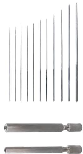
Der 13-teilige Düsen-Reibbahnen-Satz wird zum Reinigen von Düsen eingesetzt. Der Satz besteht aus zwei Werkzeughaltern und elf Reibbahnen mit unterschiedlichen Durchmessern im Bereich von 0,6 bis 1,9 mm.
