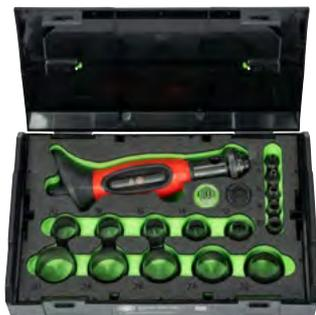
Der 16-teilige Ringstanzwerkzeug-Satz wird zum Lochen oder Herstellen von Dichtungen und Dichtungsringen aus Gummi, Leder, Filz, Kunststoff, Kork sowie Stoffen eingesetzt. Dank der doppelten Aufnahme lassen sich Dichtungsringe in nur einem Arbeitsgang herstellen, indem gleichzeitig zwei Stanzmesser mit unterschiedlichem Durchmesser am Stanzeisenhalter befestigt werden. Die Stanzmesser sind besonders scharf zugeschnitten. Dies ermöglicht die Bearbeitung unterschiedlichster Materialien.
