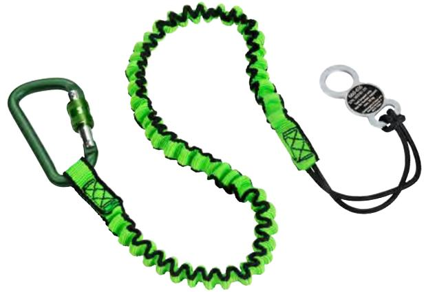
Die Fallsicherung der Baureihe 660 wird zur Sicherung und Absturzverhinderung des Abziehers bei der Anwendung genutzt. Der Karabinerhaken ist dazu in der Lage, den Abzieher an einer vorgesehenen Befestigungsmöglichkeit anzubringen. Der Befestigungsring verhindert ein Abstürzen des Werkzeugs.
