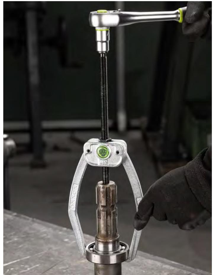
Demontage eines Kugellagers von einem Getrieberad
