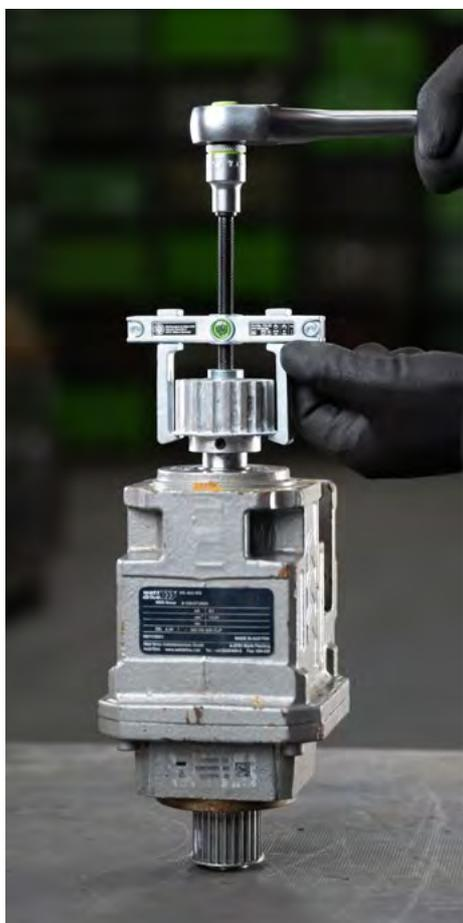
Abziehen einer Riemenscheibe von einem Maschinenge-triebe mit dem 110-02
