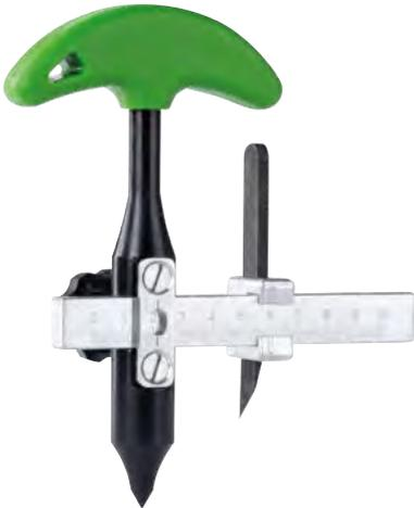
Der Scheibenschneider wird zum Schneiden von Scheiben, Leder, Papier, Pressspan und Kunststoff sowie zum Herstellen von Dichtungsringen eingesetzt. Das scharfe Schneidmesser wird auf einer Schiene geführt und kann millimetergenau ausgerichtet werden.
