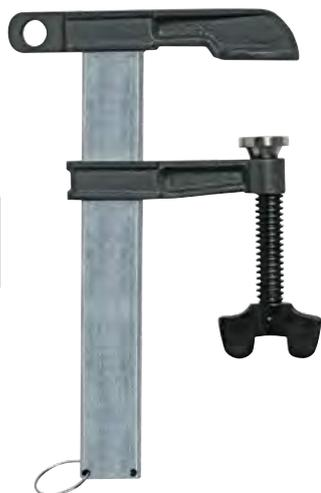
Die Pol-Schraubzwingen der Baureihe 440 werden für Erdungen bei Schweißarbeiten genutzt. Die solide und anwendungsorientierte Bauart ermöglicht ein sicheres Spannen. Die Baureihe 440 hat dabei einen Führungsring für Massekabel.
