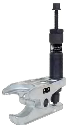
Der Kugelgelenk-Ausdrücker mit Hydraulikspindel für schwere LKW der Baureihe 129 wird zum hydraulischen Ausdrücken der Kugelzapfen beim Ausbau von Kugelgelenken an Schub- und Spurstangen speziell für mittlere und schwere LKW, Busse und Baufahrzeuge genutzt. Die Baureihe 129 überzeugt durch ihre Anwendungsvielfalt. Die Hydraulikspindel garantiert ein leichtes und kontrolliertes Abziehen von besonders festsitzenden Teilen bei geringem Kraftaufwand.
