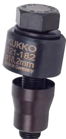
Die Schraublocher der Baureihe 121 werden zum gleichmäßigen Lochen von Kunststoffstoßfängern für Abstandssensoren sowie zum Stanzen von Löchern in dünnwandigen Materialien eingesetzt. Bei dem Arbeitsvorgang wird das Werkstück nicht deformiert. Jeder Schraublocher besteht aus einem Stempel, einer Matrize und einer Druckschraube in besonders stabiler Ausführung.
