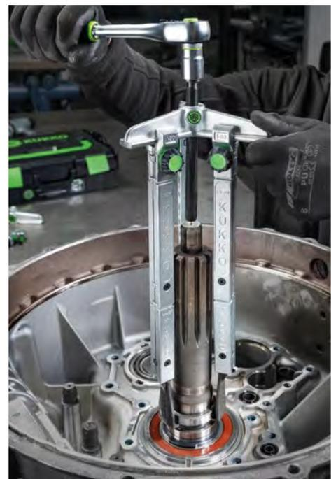
3-armiger Abzieher mit verlängerten, schmalen Abzugshaken beim Abziehen eines Kugellagers
