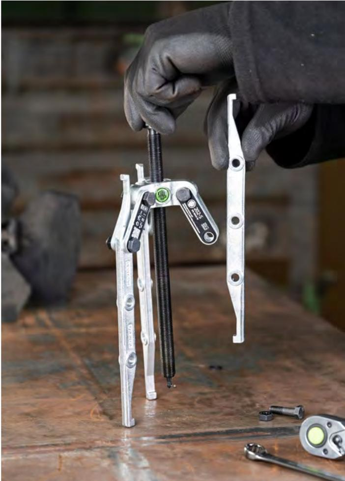
Die Mehrfachbohrungen in den Abziehschenkeln garantieren eine individuelle Anpassung an die Spanntiefe
