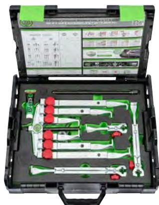
Der 13-teilige Universal-Abzieher-Satz mit schnellverstellbaren Abzugshaken der Baureihe 2030 wird zum 2- und 3-armigen Abziehen von Lagern, Zahnrädern, Scheiben etc. in Handwerk, Industrie und Werkstatt genutzt. Die Baureihe 2030 überzeugt durch ihre vielfältigen Kombinationsmöglichkeiten. Der Bausatz ermöglicht durch die Kombination von Abzugshaken und Verlängerungen den Zusammenbau von 8 verschiedenen Varianten.
