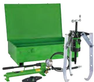
Die 9- bzw. 15-teiligen, hydraulischen Außen-Abziehersätze werden zum Abziehen von besonders großen und festsitzenden Lagern, Zahnrädern, Scheiben etc. in Industrie und NFZ genutzt. Das Set benötigt kein weiteres Zubehör zur Anwendung. Neben einem hydraulischen Hohlkolbenzylinder mit Handpumpe, Manometer und Schlauch befinden sich im Set 2- und 3-armige Abzieher, um eine Lösung für verschiedene Situationen beim Außenabziehen gewährleisten zu können.
