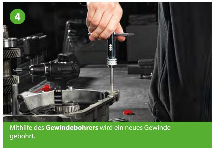
Mithilfe des **Gewindebohrers** wird ein neues Gewinde gebohrt.
