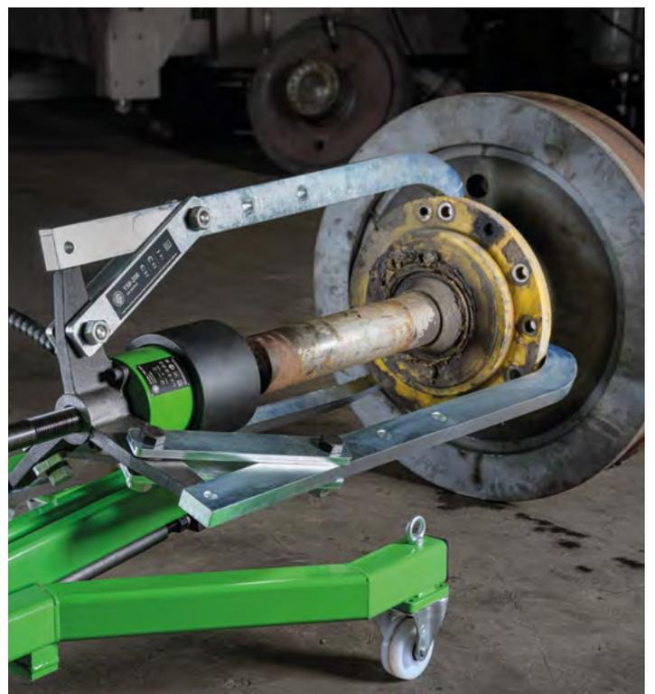
Der Mobile Hydraulik-Abzieher „GOLIATH“ Goliath-556 beim Abziehen eines festsitzenden Radlagers eines Hafenkranes
