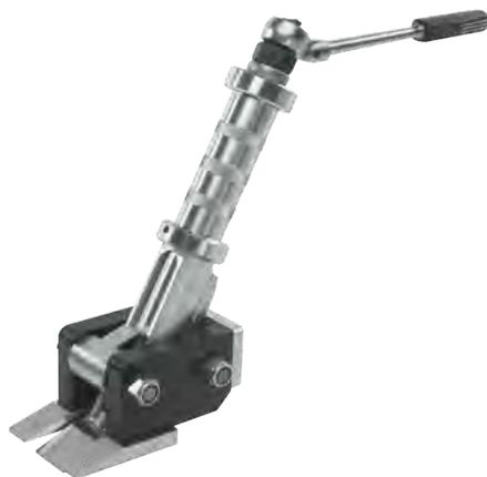
Der Universal-Spreizer der Baureihe 165 wird zum schnellen und sicheren Auseinanderspreizen von Flanschen und ähnlichen Teilen aller Art und Größen in der Industrie genutzt. Es handelt sich hierbei um ein Universalwerkzeug für viele Einsatzmöglichkeiten, das für eine paarweise Verwendung konzipiert wurde.
