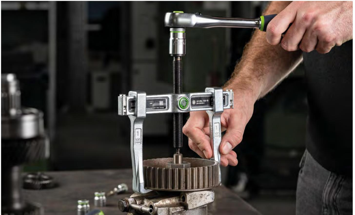
Abziehen eines Getriebezahnrades mit dem 120-10
