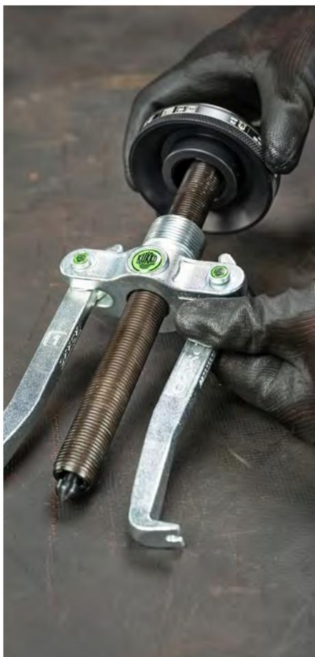
Montieren des um 180° gedrehten Spannkonus
