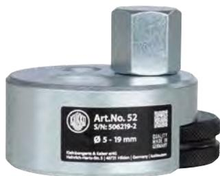
Der Stehbolzen-Ausdreher mit Innenverzahnung der Baureihe 52 wird zum Ausdrehen von Stehbolzen oder abgerissenen Bauteilen in Automotive und Industrie genutzt. Stehbolzen-Ausdreher von Kukko sind in verschiedenen Durchmessern und Ausführungen verfügbar. Die Baureihe 52 hat einen besonders großen Spannbereich und ermöglicht so durch die tiefe Anordnung des Rändelrades auch das Erfassen kurzer Stehbolzenenden.
