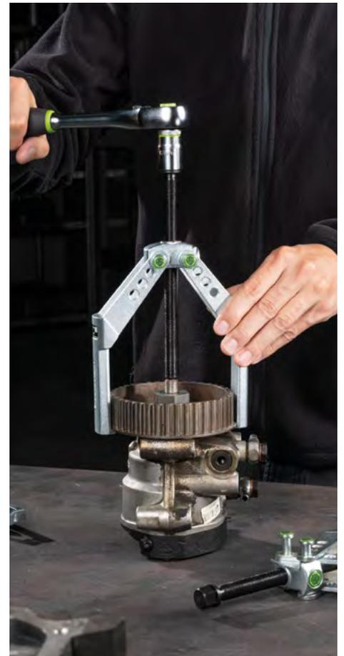
Die Entkreuzung der Abziehschenkel erhöht den Spannweitenbereich um ein Vielfaches
