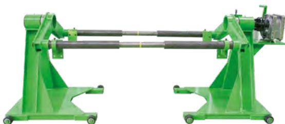
Der Motormontagebock der Baureihe W-6066 wird zur doppelseitigen Aufnahme von verschiedenen Motoren in Industrie und Werkstatt genutzt. Er besteht aus 1 angetriebenem Lagerbock, 1 Gegenlagerbock, 2 Jochen, 4 Tragarmen, 4 Spannpratzen und 2 Verbindungsrohren und ist dank auswechselbarer Spannpratzen für verschiedene Motoren geeignet.
