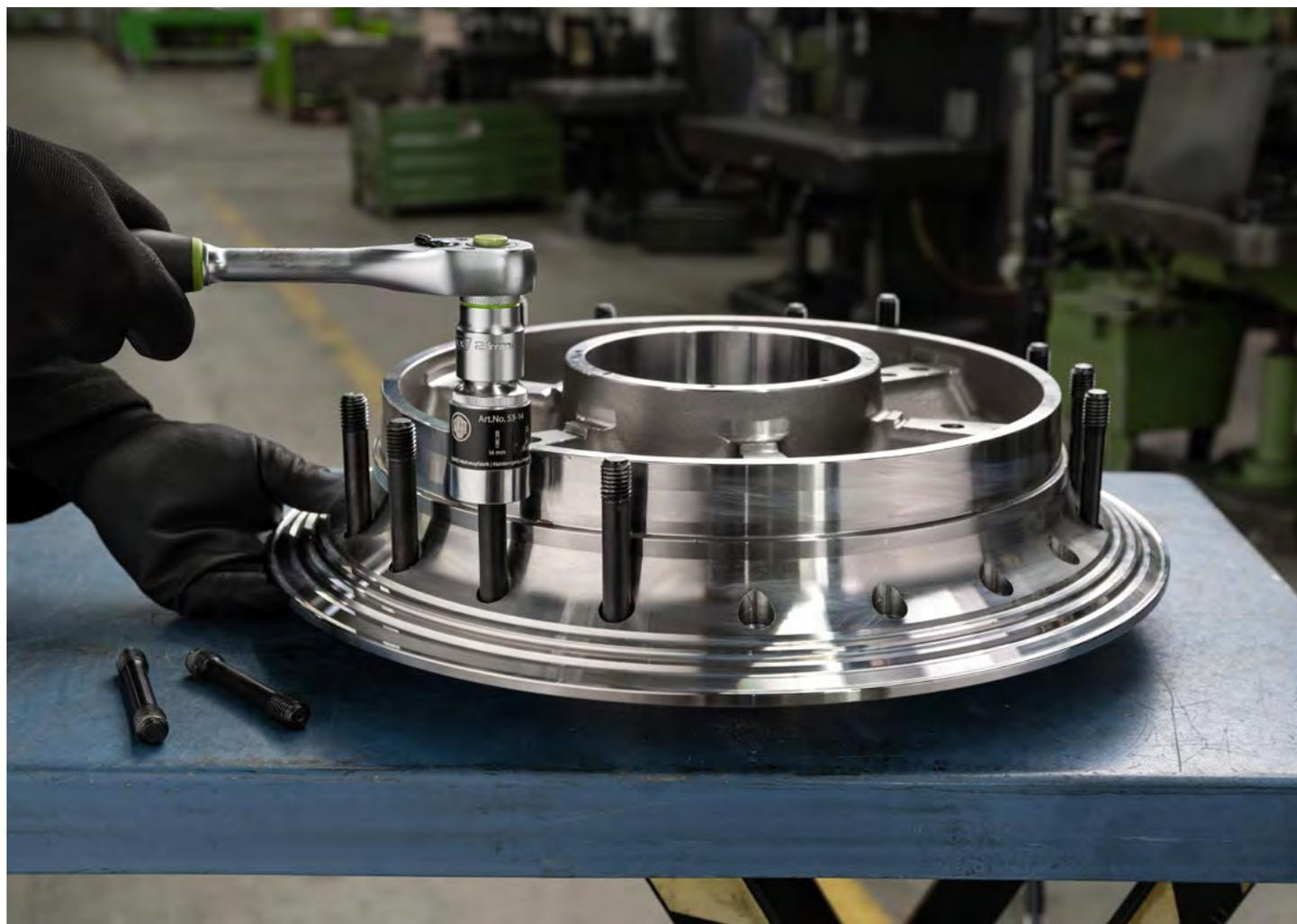
Ausdrehen eines Stehbolzens aus dem Rad einer Straßenbahn (Baureihe 53)
