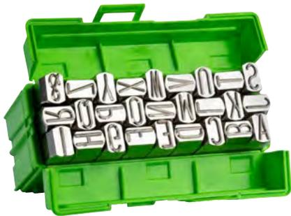
Der 27-teilige Schlagbuchstabensatz wird zur problemlosen Kennzeichnung von Werkstücken genutzt. Der Satz besitzt ein genormtes Schriftbild nach DIN 1451 und eine Härte an der Gravur zwischen 58 und 61 HRC.
