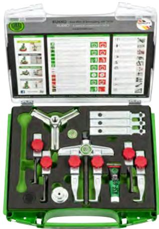
Der 13-teilige Universal-Abzieher-Satz (2- und 3-armig) mit schmalen, schnellverstellbaren Abzugshaken der Baureihe 2030 wird zum Abziehen von Lagern, Zahnrädern, Scheiben etc. für enge und schlecht zugängliche Zwischenräume in Handwerk, Industrie und Werkstatt genutzt. Die Baureihe 2030 überzeugt durch ihre vielfältigen Kombinationsmöglichkeiten. Der Bausatz ermöglicht durch die Kombination von Abzugshaken und Verlängerungen den Zusammenbau von 8 verschiedenen Varianten.
