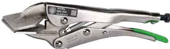
Die Breitmaul-Gripzangen der Baureihe 694 werden zum Spannen von Kanten und Flächen in Werkstatt, Industrie und Handwerk genutzt. Die Gripzangen sind nicht nur handlich und können einhändig bedient werden, durch die Kniehebel-Mechanik lassen sich zudem sehr hohe Kräfte aufbringen. Die Baureihe 694 kann durch ihre Maulform zum Spannen, Biegen und Bördeln dünner, weicher Bleche genutzt werden.
