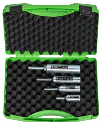
Der Satz Verlängerungen für Innenauszieher der Baureihe 21 wird zum Lösen und Ausziehen tiefsitzender Lager, Lageraußenringe und Buchsen in Handwerk, Werkstatt und Industrie eingesetzt. Die in verschiedenen Längen verfügbaren Verlängerungen gestatten eine variable Anwendung der Innenauszieher selbst in Extremfällen. Im Satz befinden sich Verlängerungen in vier verschiedenen Größen von 40 - 280 mm für die Kompatibilität in jedem Fall.
