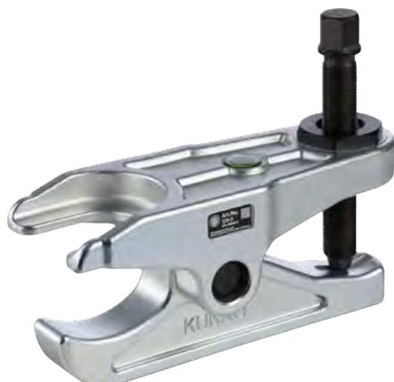
Der Kugelgelenk-Ausdrücker für schwere LKW der Baureihe 129 wird zum hydraulischen Ausdrücken der Kugelzapfen beim Ausbau von Kugelgelenken an Schub- und Spurstangen speziell für mittlere und schwere LKW, Busse und Baufahrzeuge genutzt. Die Baureihe 129 überzeugt durch ihre Anwendungsvielfalt. Der Hebelspannbereich ist über das Gewinde der Mittelspindel verstellbar.
