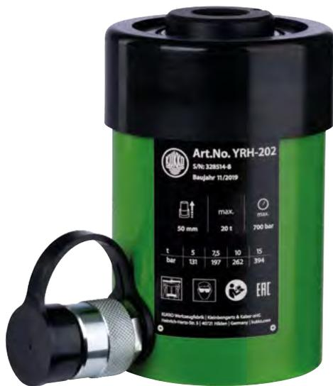
Die Hydraulischen Hohlkolbenzylinder der Baureihe YRH werden für die Verwendung mit dem KUKKO-Hydraulikprogramm in Handwerk, Industrie und Werkstatt genutzt. Sie können sowohl als Druck-, als auch als Zugzylinder eingesetzt werden und ermöglichen auf diese Weise ein kraftschonendes und vielseitiges Arbeiten auch in schwierigen Abziehsituationen oder wenn viel Kraft benötigt wird.
