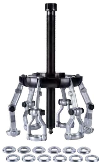
Der Radnabenabzieher mit Scheibentraverse wird zum Abziehen von Radnaben an LKW eingesetzt. Auf der Traverse können bis zu sechs Abzugshaken in unterschiedlichen Positionen eingehängt werden. Die Haken lassen sich zudem auf zwei verschiedene Längen einstellen. Dadurch ist der Abzieher auch bei variablen Lochkreisdurchmessern universell einsetzbar.
