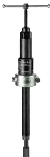
Die fetthydraulische Spindel der Baureihe 8 ist der Motor des Abziehers und erreicht eine mittlere Zugkraft von 20 t. Die Hydraulikspindel eignet sich zum Abziehen von besonders festsitzenden Lagern, Zahnrädern und Scheiben, die mit reiner Muskelkraft nicht zu lösen sind. Dank integrierter Fett-Hydraulik ist keine externe Pumpe erforderlich.
