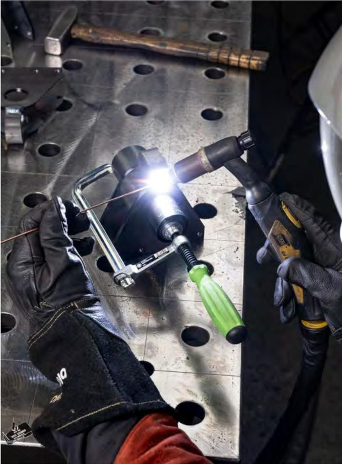
Bei Schweißarbeiten fungiert die Ganzstahl-Schraubzwinde als "dritte Hand". Das Bild zeigt ein Modell der Baureihe 469P.
