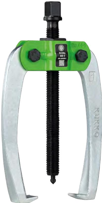
Die robusten, 2-armigen Industrie-Abzieher der Baureihe 44 werden zum kraftvollen Abziehen von größeren Bauteilen eingesetzt. Mit Aufbau des Spindeldrucks wird das abziehende Teil von den miteinander verbundenen Abziehschenkeln immer fester umschlossen.
