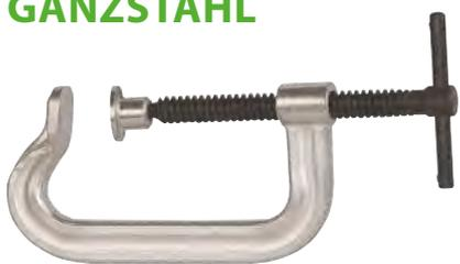
Die C-Schraubzwingen aus Ganzstahl der Baureihe 365 werden für federndes elastisches Spannen mehrerer Werkstücke in Handwerk, Industrie und Werkstatt genutzt. Die Schraubzwinde sorgt durch ihre Trapezspindel für eine besonders hohe Presskraft. Die Baureihe 365 hat einen Knebelgriff, der ein besonders festes Anziehen ermöglicht.
