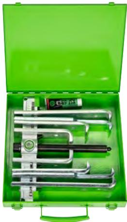
Der 2-armige Universal-Abzieher "Economy" mit einem vielseitig kombinierbaren Abziehschenkel-Set wird zum Abziehen von Lagern, Zahnrädern und Scheiben in allen gängigen Größen in der Agrarwirtschaft und Werkstatt eingesetzt. Damit lässt sich jedes Bauteil lösen, das auf einer Welle sitzt und von außen frei zugänglich ist. Durch die verschiedenen langen Abziehschenkel kann der Abzieher individuell an die jeweilige Spanntiefe angepasst werden.
