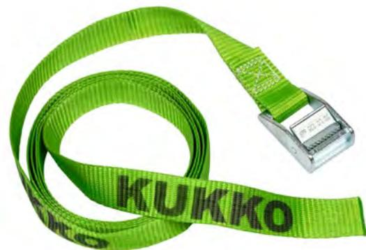
Der Spanngurt wird zum Sichern für kleine bis mittlere Lasten im Transportwesen verwendet. Das Klemmschloss verfügt über eine gerändelte Klemmbacke mit Federmechanismus, die einen festen Halt garantiert. Wenn Hakenösen am Abzieher vorhanden sind, kann der Spanngurt zum besseren Fixieren und Zusammenhalten der Abzugshaken genutzt werden.
