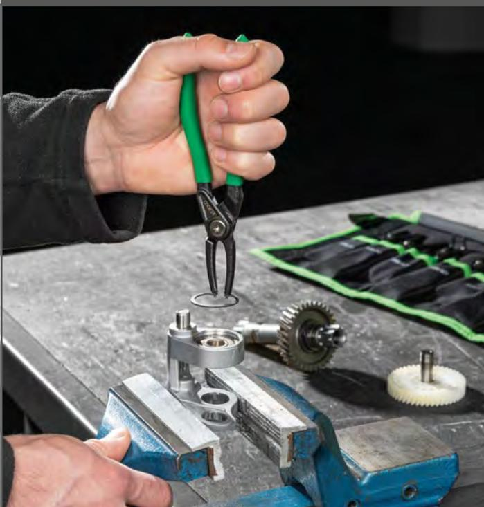
Ausziehen eines Sicherungsrings
