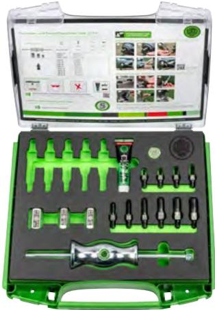
Der 14-teilige Passfeder- und Passstiftauszieher-Satz wird zum Ausziehen von Buchsen sowie von Bauteilen mit Gewinden (Passstifte, Passfedern, Bolzen, etc.) in Handwerk, Industrie und Werkstatt genutzt. Neben einer Gleithammer-Vorrichtung sind verschiedene Gewindeeinsätze enthalten, um Teile in verschiedenen Größen ausziehen.
