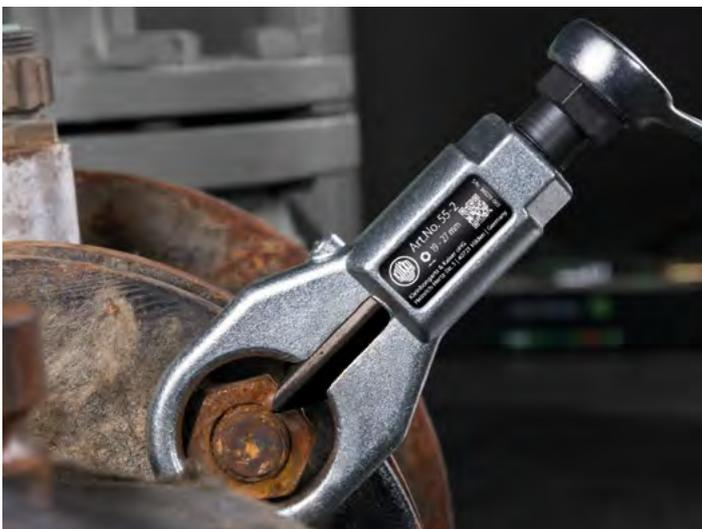
Durch das Anziehen der Spindel wird der Meißel in die zu sprengende Mutter gedrückt
