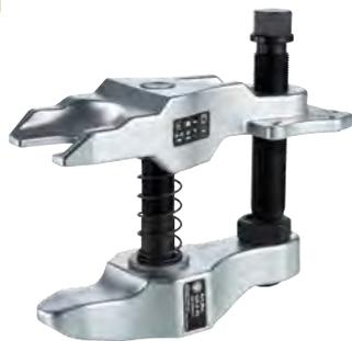
Der Spur- und Schubstangengelenk-Abzieher für schwere LKW der Baureihe 129 wird zum mechanischen Ausdrücken der Kugelzapfen beim Ausbau von Kugelgelenken an Schub- und Spurstangen genutzt. Die Baureihe 129 überzeugt durch ihre Anwendungsvielfalt. Innerhalb der Baureihe gibt es verschiedene Größen an Kugelgelenk-Ausdrücker mit unterschiedlichen Gabelöffnungen. Der Hebelspannbereich ist über das Gewinde der Mittelspindel verstellbar.
