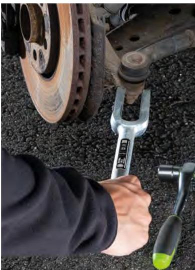
Trennen eines Querlenkers von der Radaufhängung
