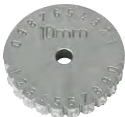
Der Radschlagstempel für Ziffern der Baureihe 332 wird gemeinsam mit einem Stempelhalter zum problemlosen Kennzeichnen von Zahlenreihen in Werkstücken mit einer Festigkeit von bis zu 1300 N/mm<sup>2</sup> in Handwerk, Industrie und Werkstatt genutzt. Der Satz besitzt eine Härte an der Gravur zwischen 58 und 61 HRC. Die Radschlagstempel der Baureihe 332 sind durch ihre vernickelte Oberfläche besonders für das Kennzeichnen von Edelstahl geeignet.
