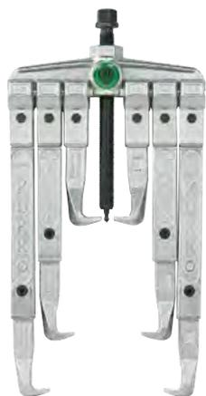
Der 2-armige Universal-Abzieher mit verstellbaren Abzugshaken wird zum besonders sicheren Abziehen von Lagern, Zahnrädern und Scheiben in allen gängigen Größen für Handwerk, Werkstatt und Industrie eingesetzt. Durch die Ausstattung mit 2 Paaren an Abzugshaken in verschiedenen Längen werden Abziehvorgänge mit diversen Kombinationen und Raumtiefen ermöglicht. Damit lässt sich jedes Bauteil lösen, das auf einer Welle sitzt und von außen frei zugänglich ist.
