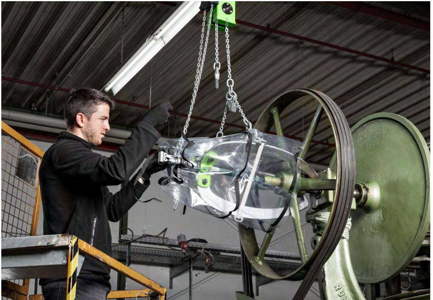
Die Unfallschutzplane UFP bietet Sicherheit beim Abziehen einer Riemenscheibe von einer Presse
