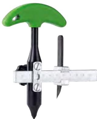
Der Scheibenschneider wird zum Schneiden von Scheiben, Leder, Papier, Pressspan und Kunststoff sowie zum Herstellen von Dichtungsringen eingesetzt. Das scharfe Schneidmesser wird auf einer Schiene geführt und kann millimetergenau ausgerichtet werden. Mit dem Scheibenschneider lassen sich exakte runde Ausschnitte im Bereich von 40 bis 200 mm Durchmesser schneiden.
