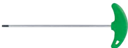
Die TX-Schraubendreher mit T-Griff der Baureihe 212 werden für das Betätigen von Schraubenköpfen in Werkstatt, Industrie und Handwerk genutzt. Anders als bei Inbusschlüsseln greift das Torx-Profil mittig an und sorgt so für leichteres Arbeiten und weniger Verschleiß. Die Baureihe 212 ist preiswert und kompakt.
