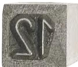
Die Handschlagstempel der Baureihe 300 werden zur problemlosen Kennzeichnung von Werkstücken mit einer Festigkeit von bis zu 900 N/mm<sup>2</sup> (27 HRC) in Handwerk, Industrie und Werkstatt genutzt. Die Stempel besitzen eine Härte an der Gravur zwischen 58 und 61 HRC. Jeder Handschlagstempel wird individuell nach ihren Wünschen gefertigt. Auch Sonderzeichen, Zahlen und Buchstaben können je nach Bedarf kombiniert werden und sind auf Anfrage auch umrandet lieferbar.
