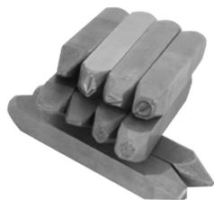
Die Handschlagstempel mit Sonderzeichen der Baureihe 300 werden zur problemlosen Kennzeichnung von Werkstücken mit einer Festigkeit von bis zu 900 N/mm<sup>2</sup> (27 HRC) in Handwerk, Industrie und Werkstatt genutzt. Die Stempel besitzen eine Härte an der Gravur zwischen 58 und 61 HRC. Sonderzeichen wie Erdungszeichen, Durchmesserzeichen usw. sind mit einer festen Artikelnummer einfach bestellbar.
