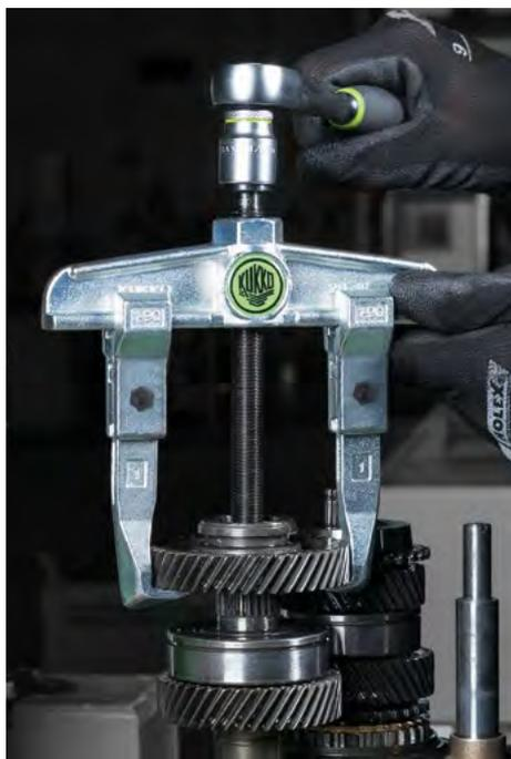
Abziehen eines Getriebezahnrades mit dem 20-10
