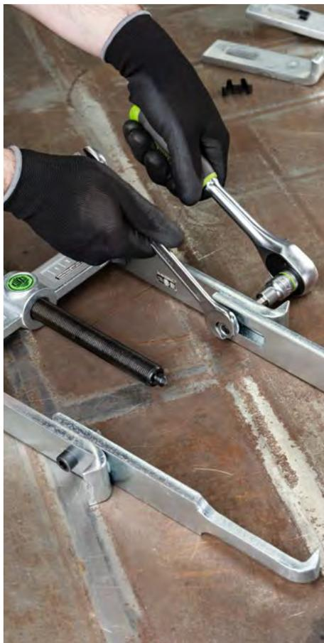
Per Schraubverbindung können die Abziehschenkel miteinander verbunden werden
