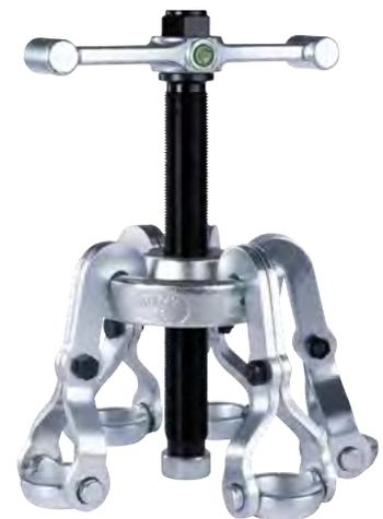
Der Radnabenabzieher mit Scheibentraverse wird zum Abziehen von Radnaben an LKW eingesetzt. Auf der Scheibentraverse können bis zu fünf Abzugshaken eingehängt werden, die auf der Traverse frei beweglich sind. Dadurch ist der Abzieher auch bei verschiedenen Fahrzeugmodellen universell einsetzbar. Der freibewegliche T-Griff am Spindelkopf garantiert ein manuelles Anziehen der Spindel auf engstem Raum.
