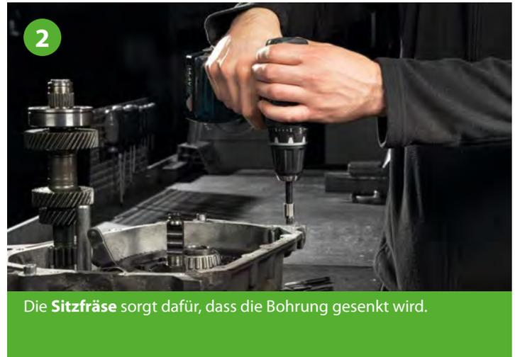
Die **Sitzfräse** sorgt dafür, dass die Bohrung gesenkt wird.
