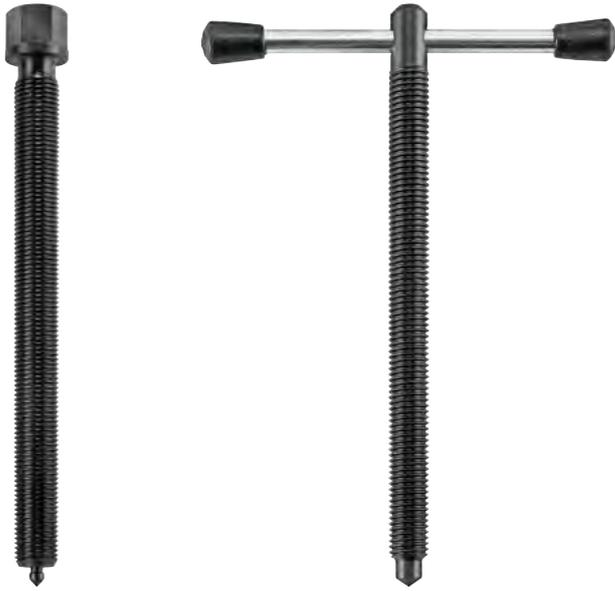
Die mechanische Druckspindel ist das Herzstück eines jeden KUKKO Abziehers. Damit lässt sich eine maximale Zugkraft von 10 t erzielen. Die manuelle Betätigung der Spindel sorgt für eine gefühlvolle Kontrolle des Abziehvorgangs. Das Feingewinde garantiert zudem eine perfekte Kraftübertragung. Eine umkehrbare Spindelspitze ermöglicht sowohl auf glatten Oberflächen als auch bei Zentrierungen ein sicheres Aufsetzen der Spindel.
