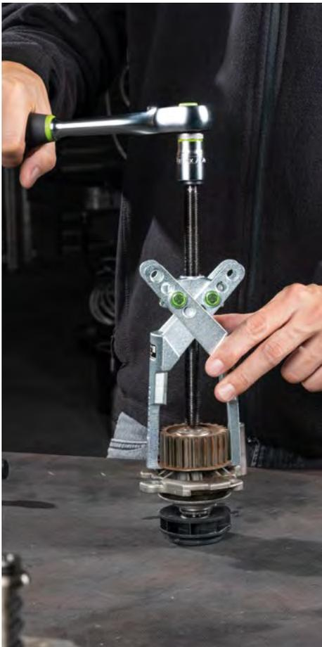
Die scherenartige Hakenführung sorgt für einen sicheren Halt. Die Krallenfüße umfassen die Riemenscheibe
