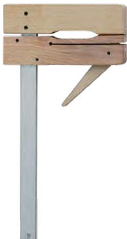
Die Holzklammzwingen der Baureihe 511 werden zum Pressen und Spannen mehrerer Werkstücke eingesetzt. Die Zwingen sind speziell für Holzteile konzipiert worden und bestehen aus einem massiven Oberteil, Unterteil und Exzenter aus Buchenholz sowie einer Stahlschiene. Dies garantiert eine ideale Handhabung dank stufenloser Einstellung des Spanndrucks durch den Exzenterhebel. Die rutschsichere Korkauflage verhindert Druckstellen oder sonstige Beschädigungen.
