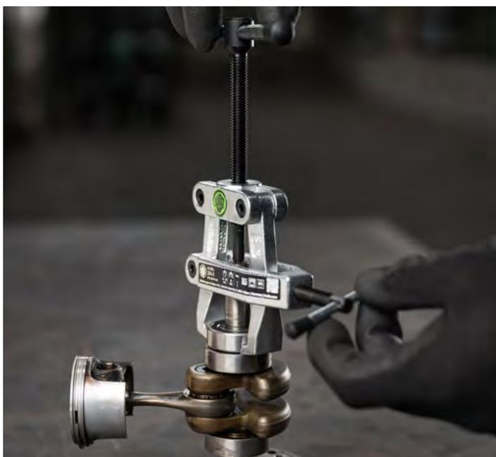
Abziehen eines Kugellagers von einer Kurbelwelle einer Kettensäge mit dem 204-0
