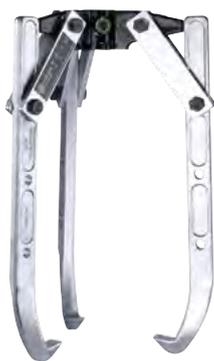
Die 3-armigen Abzieher mit schwenkbaren Abzugshaken der Baureihe Y-206 werden zum Abziehen von besonders großen und festsitzenden Lagern, Zahnrädern, Scheiben etc. in Handwerk, Industrie und Werkstatt genutzt. Durch die einfache Verstellbarkeit ist der Abzieher auch bei verschiedenen Abziehsituationen geeignet. Zur Anwendung wird noch ein Hydraulischer Hohlkolbenzylinder der Baureihe YRH benötigt.
