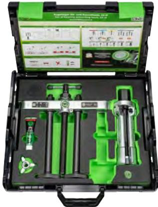
Der 3-teilige Kugellager-Auszieh-Satz 25-D wird zum Ausziehen innenliegender Lager, Lageraußenringe und Buchsen in Handwerk, Industrie und Werkstatt genutzt. Im Set enthalten sind Innenauszieher und Gegenstützen. Die mehrschalige Ausführung der Innenauszieher mit ihren extra großen Greifkanten erlaubt das sichere Ausziehen innenliegender Teile, und gemeinsam mit den Gegenstützen können so innenliegende Teile sicher entfernt werden.
