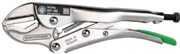
Die Prisma-Gripzangen der Baureihe 691 werden zum sicheren Festhalten von Rund-, Profil- und Flachmaterial in Werkstatt, Industrie und Handwerk genutzt. Die Gripzangen sind nicht nur handlich und können einhändig bedient werden, durch die Kniehebel-Mechanik lassen sich zudem sehr hohe Kräfte aufbringen. Die Baureihe 691 besitzt eine Draht- rille in der Oberbacke, wodurch auch Nägel und Drähte von vorne greif- und führbar werden.
