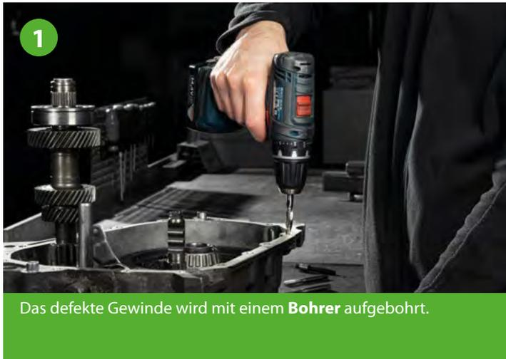
Das defekte Gewinde wird mit einem **Bohrer** aufgebohrt.
