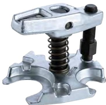
Der Kugelgelenk-Ausdrücker mit Hebelübersetzung der Baureihe 129 wird zum Ausdrücken der Kugelzapfen beim Ausbau von Kugelgelenken sowie Spurstangenknöpfe an Spurstangen, universell für PKW, Lieferwagen und mittlere LKW genutzt. Durch seine Hebelübersetzung kann der Kugelgelenk-Ausdrücker auch dort viel Kraft anwenden, wo kaum Zugriffsplatz vorhanden ist. Die Baureihe 129 überzeugt durch ihre Anwendungsvielfalt. Der Hebelspannbereich ist über das Gewinde der Mittelspindel verstellbar.
