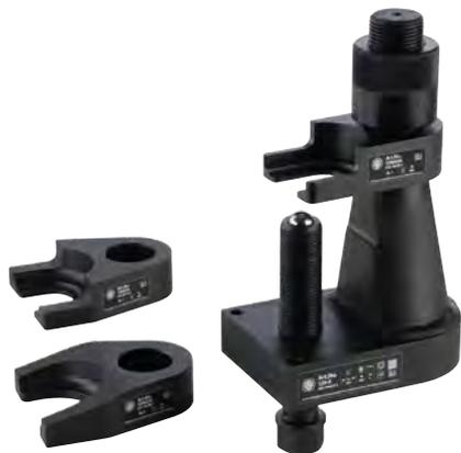
Der LKW-Kugelgelenk-Ausdrücker „Universal“ der Baureihe 129 wird zum Ausdrücken besonders festsitzender Kugelzapfen beim Ausbau von Kugelgelenken an Schub- und Spurstangen bei LKW, Bussen und Baufahrzeugen genutzt. Die Baureihe 129 überzeugt durch ihre Anwendungsvielfalt.
