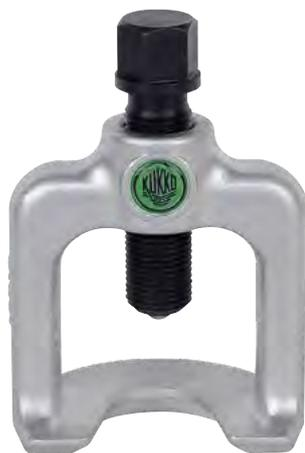
Der glockenförmige Kugelgelenkabzieher der Baureihe 128 wird zum Ausdrücken der Kugelzapfen beim Ausbau von Kugelgelenken sowie Spurstangenköpfe an Spurstangen für alle Fahrzeugtypen genutzt. Der Abzieher ermöglicht ein beschädigungsfreies Arbeiten und ist optimal, wenn viel Platz vorhanden ist. Die Baureihe 128 überzeugt durch ihre schnelle und einfache Arbeitsweise und ist in verschiedenen Größen verfügbar.
