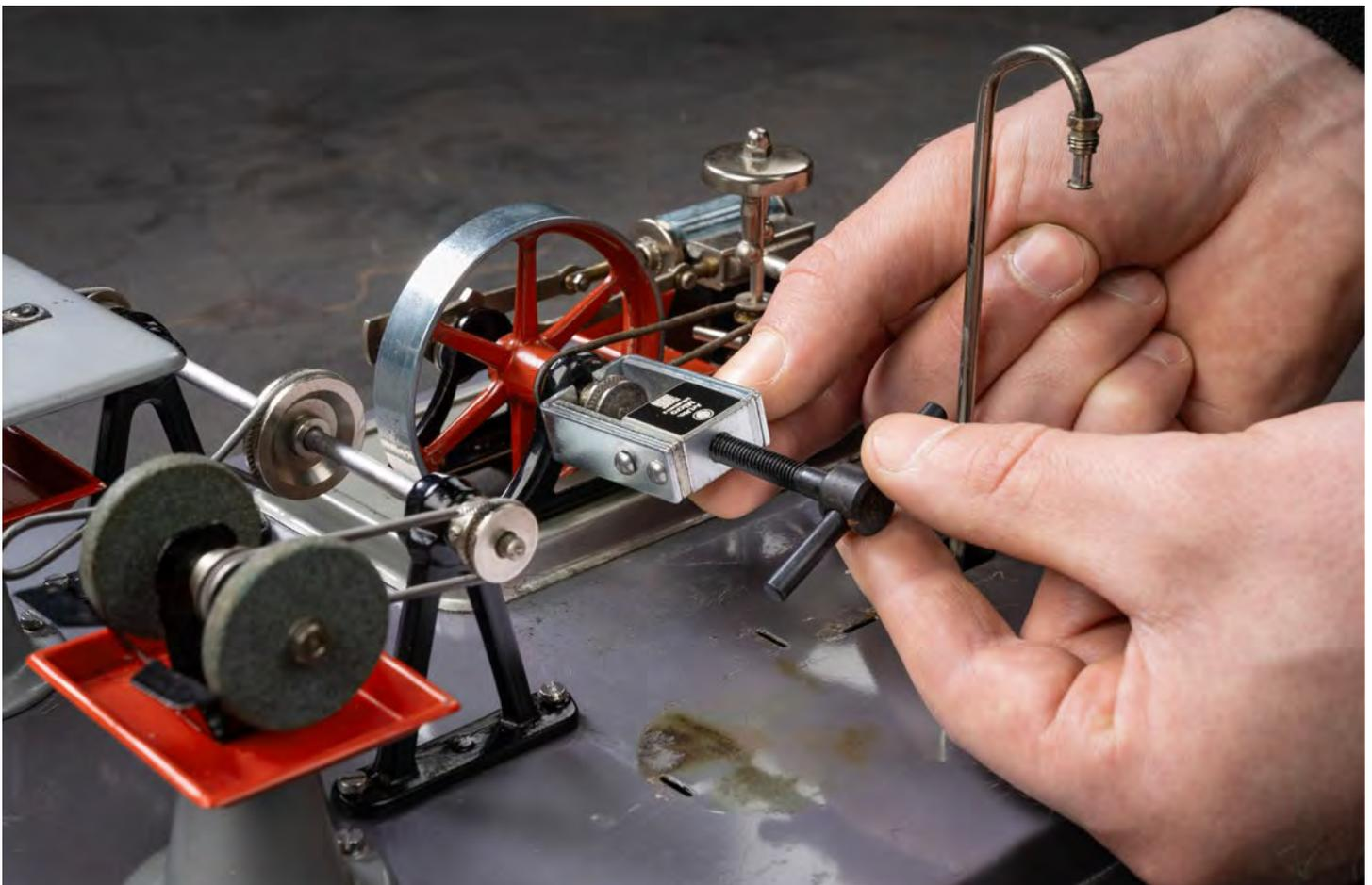
Abziehen einer Riemscheibe von einer Miniaturdampfmaschine
