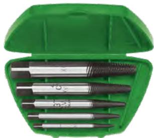
Der 5-teilige Schraubenausdreher-Satz mit fein gerillter Form wird zum Ausdrehen von abgebrochenen Bolzen und Schrauben mit Rechtsgewinde eingesetzt. Die Schraubenausdreher sind ein unentbehrliches Werkzeug, auf das weder Hobbyschrauber noch Handwerkerprofi verzichten kann. Im Set enthalten sind Schraubenausdreher für Gewindedurchmesser ab M3 und je nach Ausführung bis zu einem Durchmesser von M18 (49-A), M24 (49-B) oder M45 (49-C).
