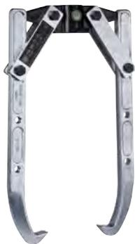
Die 2-armigen Abzieher mit schwenkbaren Abzugshaken der Baureihe Y-205 werden zum Abziehen von besonders großen und festsitzenden Lagern, Zahnrädern, Scheiben etc. in Handwerk, Industrie und Werkstatt genutzt. Durch die einfache Verstellbarkeit ist der Abzieher auch bei verschiedenen Abziehsituationen geeignet. Zur Anwendung wird noch ein Hydraulischer Hohlkolbenzylinder der Baureihe YRH benötigt.
