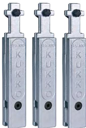
Der Satz Abzugshakenverlängerungen wird zur Erweiterung der Spanntiefe eingesetzt. Dadurch lassen sich Bauteile greifen, die besonders tief auf einer Welle sitzen. Die Verlängerungen können beliebig miteinander kombiniert und somit der erforderlichen Spanntiefe angepasst werden.
