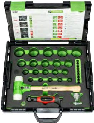
Der 33-teilige Ringstanzwerkzeug-Satz wird zum Lochen oder Herstellen von Dichtungen und Dichtungsringen aus Gummi, Leder, Filz, Kunststoff, Kork sowie Stoffen eingesetzt. Dank der doppelten Aufnahme lassen sich Dichtungsringe in nur einem Arbeitsgang herstellen, indem gleichzeitig zwei Stanzmesser mit unterschiedlichem Durchmesser am Stanzeisenhalter befestigt werden. Die Stanzmesser sind besonders scharf zugeschnitten. Dies ermöglicht die Bearbeitung unterschiedlichster Materialien.
