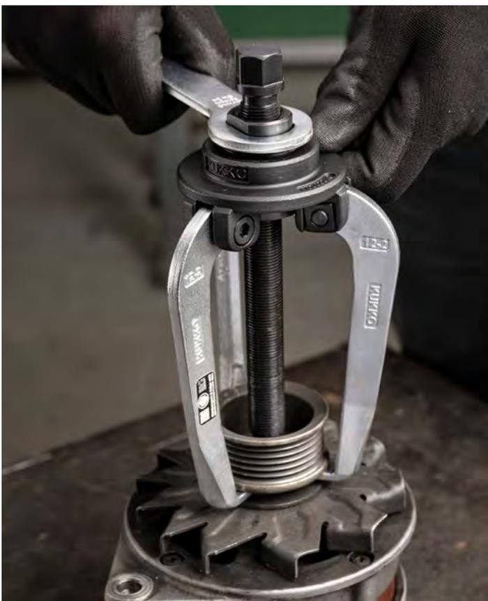
Entfernen einer Riemenscheibe von einem PKW-Generator
