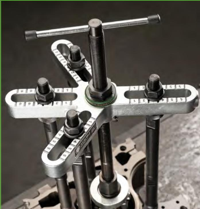
Die neue Multi-Traverse der Baureihe 68er bietet Platz für bis zu vier Fußbolzen. Dies garantiert eine größere Auflagefläche und somit eine gleichmäßigere Kraftverteilung.
