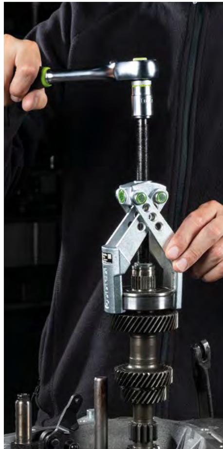
Abziehen eines Kugellagers von einer Getriebewelle
