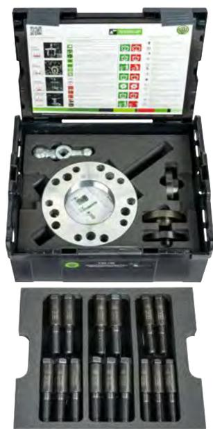
Das Hydraulische Radnabenabziehwerkzeug für NFZ und Niederflrbusse wird zur sicheren und schnellen Demontage der Radnabe bei NFZ und Bussen in der Automotive genutzt. Die Lochkreisscheibe und der 30 t Druckzylinder sind dazu in der Lage, sehr festsitzende und schwierig zu entfernende Radnaben zu lösen.
