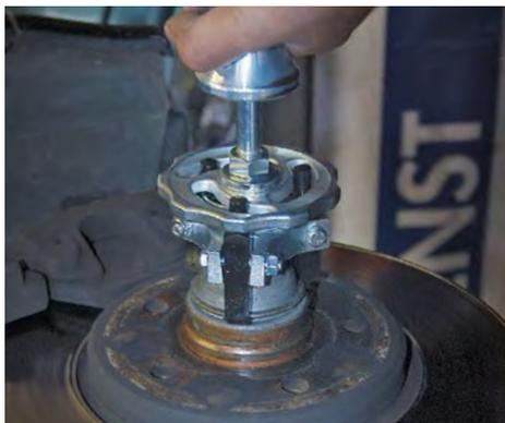
Zunächst wird mit dem Abzieher der Baureihe 225-SK die Staubkappe von der Radnabe entfernt
