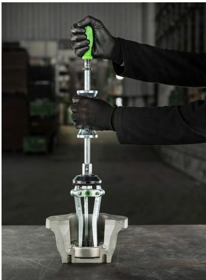
Innenausziehen eines Kugellagers aus einem Gehäuse
