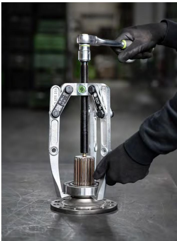
Abziehen eines Kugellagers mit dem schweren Laschenabzieher 207-02
