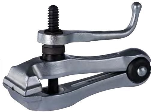
Die Handfeilkloben mit breitem Maul und Schlüssel der Baureihe 103 werden zum flächigen Spannen von Werkstücken in Werkstatt, Industrie und Handwerk genutzt. Die Backeninnenseite ist dabei mit einem prismatischen Einschnitt geriffelt, sodass runde und kantige Teile gespannt werden können. Die Baureihe 103 überzeugt durch ihre Handlichkeit, die ein Drehen und Wenden des Werkstücks beim Arbeiten ermöglicht.
