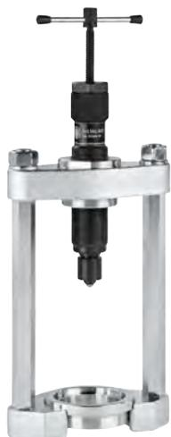
Die Universal-Pressrahmen für Silentbuchsen werden zum Lagerwechsel an Vorder- und Hinterachse ohne Ausbau der Achse in der Automotive genutzt, z.B. bei Silentlagern, Hydrolagern, Kunststofflagern, Traggelenken oder Stoßdämpfergummi. Die Pressrahmen der Baureihe 880 sind in verschiedenen Ausführungen für variierende Belastungsanforderungen verfügbar und universell einsetzbar.
