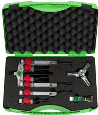
Der 9-teilige Universal-Abzieher-Satz mit schmalen Abzughaken der Baureihe KS-2030-1-193+S wird zum Abziehen von Lagern, Zahnrädern, Scheiben etc. für enge und schlecht zugängliche Zwischenräume in Handwerk, Industrie und Werkstatt genutzt. Der Bausatz ermöglicht das Wechseln zwischen 2- und 3-armigen Abziehen und verschiedenen Haken, wodurch sich 4 verschiedene Varianten ergeben.
