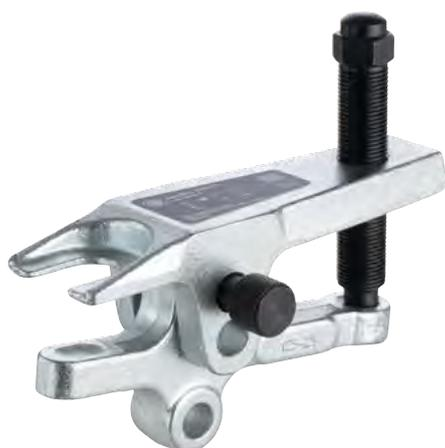
Der Universal-Kugelgelenk-Ausdrücker der Baureihe 129 wird zum Ausdrücken der Kugelzapfen beim Ausbau von Kugelgelenken an Schub- und Spurstangen bei PKW genutzt. Durch seine Hebelübersetzung kann der Kugelgelenk-Ausdrücker auch dort viel Kraft anwenden, wo kaum Zugriffsplatz vorhanden ist. Die Baureihe 129 überzeugt durch ihre Anwendungsvielfalt. Der Hebelspannbereich ist über das Gewinde der Mittelspindel verstellbar.
