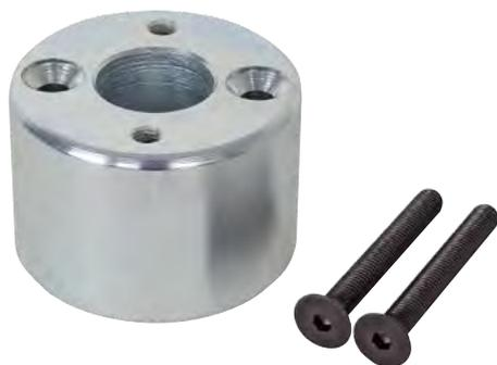
Die Zusatzgewichte der Baureihe 22-0-2-100 werden gemeinsam mit Gleithämmern der Baureihe 22-0-50 in Handwerk, Industrie und Werkstatt genutzt. Jedes Zusatzgewichtmodul erhöht dabei das Schlaggewicht des Gleithammers um jeweils 3 kg, wodurch selbst besonders fest-sitzende Teile sicher und schonend abgezogen werden können.
