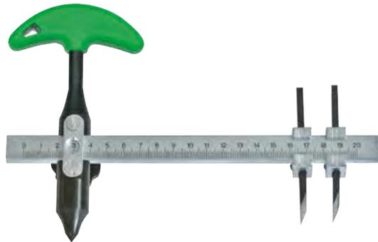
Der Scheibenschneider mit zwei Messern wird zum Schneiden von Scheiben und Dichtungsringen aus Gummi, Leder, Papier, Pressspan und Kunststoff eingesetzt. Die beiden scharfen Schneidmesser werden auf einer Schiene geführt, die millimetergenau ausgerichtet werden kann. Mit dem Scheibenschneider lassen sich exakte runde Ausschnitte im Bereich von 40 bis 200 mm Durchmesser schneiden.
