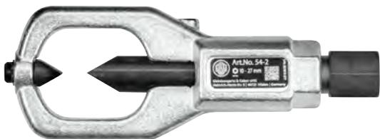
Die zweiseitigen, mechanischen Mutternsprenger werden zum Sprengen von unlösbar festsitzenden, verrosteten oder überdrehten Muttern bis zu einer Zugfestigkeit 800 N/mm<sup>2</sup> eingesetzt. Bei diesem Sprengvorgang bleibt der Gewindestift unbeschädigt. Die beiden durch einen Facettenschliff scharfen Schneiden des Meißels dringen beim Anziehen der Spindel tief in die Mutter ein, bis diese gesprengt ist. Dank doppelter Sprengwirkung ist nur ein Arbeitsschritt notwendig.
