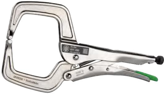
Die Klammer-Gripzangen der Baureihe 697 werden zum Klemmen, Spannen und Halten von Profil- und Flachmaterial in Werkstatt, Industrie und Handwerk genutzt. Die Gripzangen sind nicht nur handlich und können einhändig bedient werden, durch die Kniehebel-Mechanik lassen sich zudem sehr hohe Kräfte aufbringen. Die Baureihe 697 mit ihrer speziellen Form spannt auch unsymmetrische und sperrige Werkstücke und Profile mit hohen Stegen.
