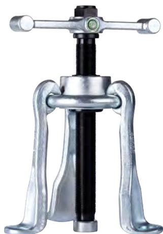
Der Radnabenabzieher mit Scheibentraverse wird zum Abziehen von Radnaben an LKW eingesetzt. Die Spindel läuft in einer axial beweglich gelagerten Gewindebüchse, falls zum Lösen der Radnabe Schläge auf den Spindelkopf erforderlich sind. Der freibewegliche T-Griff am Spindelkopf garantiert ein manuelles Anziehen der Spindel auf engstem Raum.
