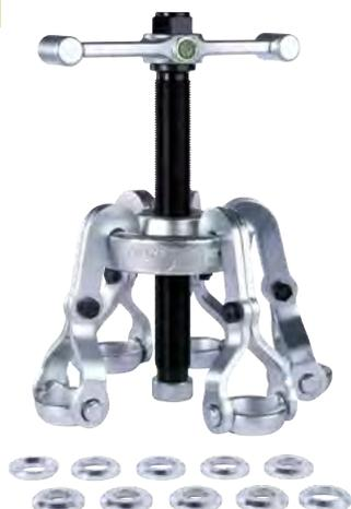
Der Radnabenabzieher mit Scheibentraverse wird zum Abziehen von Radnaben an LKW eingesetzt. Auf der Scheibentraverse können bis zu fünf Abzugshaken eingehängt werden, die auf der Traverse frei beweglich sind. Dadurch ist der Abzieher auch bei verschiedenen Fahrzeugmodellen universell einsetzbar. Der freibewegliche T-Griff am Spindelkopf garantiert ein manuelles Anziehen der Spindel auf engstem Raum.
