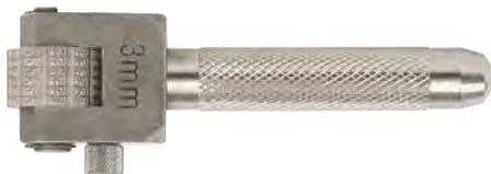
Der Radschlagstempelapparat der Baureihe 332 wird zum problemlosen Kennzeichnen von Zahlenreihen in Werkstücken mit einer Festigkeit von bis zu 1300 N/mm<sup>2</sup> in Handwerk, Industrie und Werkstatt genutzt. Der Satz besitzt eine Härte an der Gravur zwischen 58 und 61 HRC. Die Radschlagstempel der Baureihe 332 sind durch ihre vernickelte Oberfläche besonders für das Kennzeichnen von Edelstahl geeignet.
