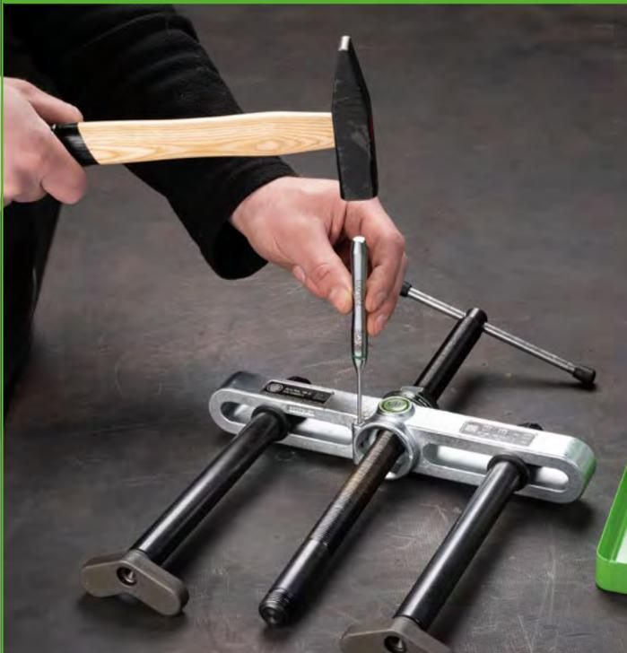
Austreiben eines Sicherungssplints mit einem Splintentreiber
