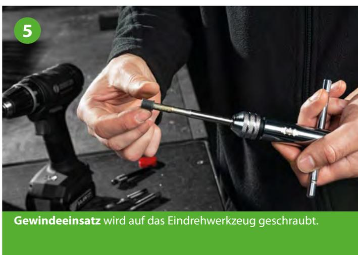
**Gewindeeinsatz** wird auf das Eindrehwerkzeug geschraubt.
