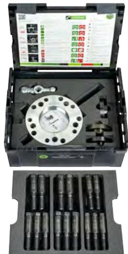
Das Hydraulische Radnabenabziehwerkzeug für NFZ und Niederflerbusse wird zur sicheren und schnellen Demontage der Radnabe bei NFZ und Bussen in der Automotive genutzt. Die Lochkreisscheibe und der 30 t Druckzylinder sind dazu in der Lage, sehr festsitzende und schwierig zu entfernende Radnaben zu lösen.
