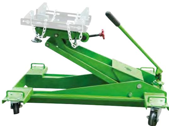
Der hydraulische Getriebeheber RHINO wird für Arbeiten an PKW- und LKW-Getrieben, Kupplungen und Differentialen genutzt. Die zweiachsig schwenkbare Grundplatte mit einstellbaren Halterungen und Ketten dient der Ausrichtung der Aufnahmen und Werkzeug-Universalaufnahme bis zu 1,5 t.
