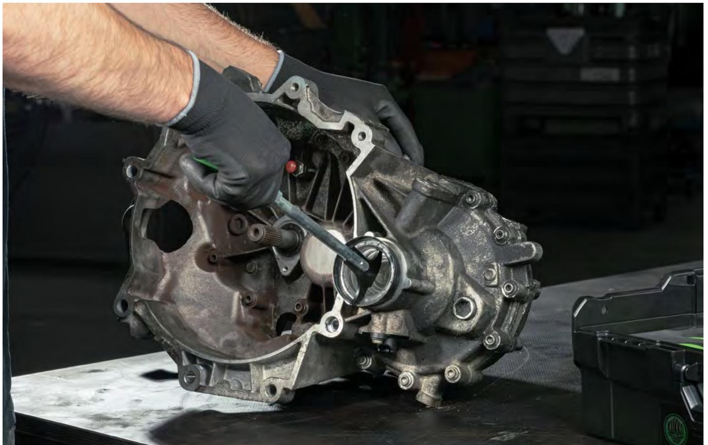
Ausbau eines Dichtringes mit dem 222-U
