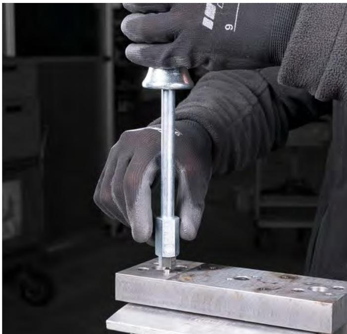
Ausziehen eines Passstiftes mittels Gleithammer, Verbindungsmutter und Gewindeadapter
