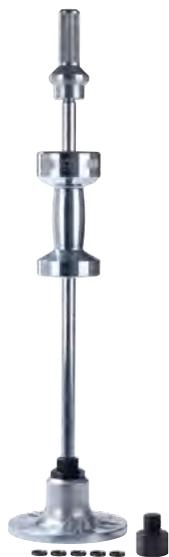
Der Radnabenabzieher mit Gleithammer der Baureihe 229 wird zum Abziehen aller 4- und 5-Loch-Radnaben fast aller PKW-Typen in Automotive genutzt. Der Flansch ist mit Schlitzen unterschiedlicher Teilung zur Aufnahme handelsüblicher Schrauben vorgesehen.
