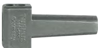
Der Typenhalter der Baureihe 333 wird gemeinsam mit Typen zum mehrstelligen Gravieren in der Industrie genutzt. Die Typen der Baureihe 333 besitzen eine Härte an der Gravur zwischen 58 und 60 HRC. Das hochflexible Graviersystem mit freier Kombination der verschiedenen Typenstempel ist dazu in der Lage, für jede Anwendung universell einsatzbereit zu sein. Die vernickelte Oberfläche hinterlässt keinen Fremdrost und eignet sich insbesondere für die Kennzeichnung von Edelstahl.
