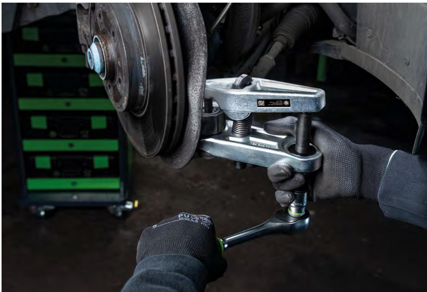
Der Kugelgelenk-Ausdrücker 129-3 beim Ausdrücken eines Spurstangenknopfes
