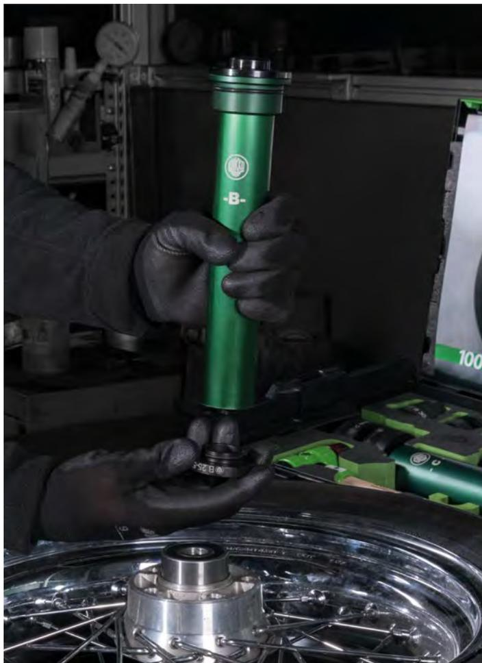
Einsetzen des passenden Schlagrings in das Schlagrohr bei Verwendung eines K-71 Satzes
