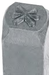
Die Handschlagstempel mit 6-Strich-Stern der Baureihe 300 werden zur problemlosen Kennzeichnung von Werkstücken mit einer Festigkeit von bis zu 900 N/mm<sup>2</sup> (27 HRC) in Handwerk, Industrie und Werkstatt genutzt. Die Stempel besitzen eine Härte an der Gravur zwischen 58 und 61 HRC. Die Stempel sind insbesondere für die Begrenzung von Texten und Seriennummern auf Typenschildern geeignet.
