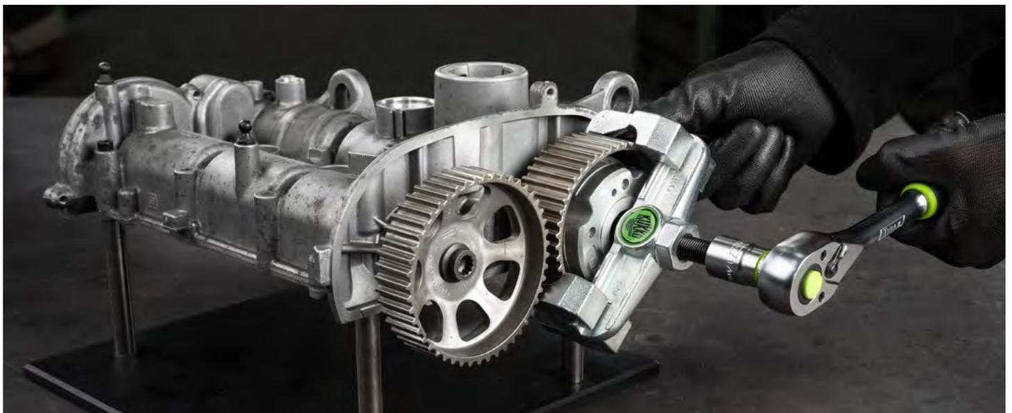
Abziehvorgang eines Nockenwellenrades mit dem 118-0 unter Verwendung der Einfinger-Klauen
