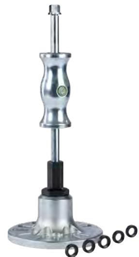
Der Radnabenabzieher mit Gleithammer der Baureihe 229 wird zum Abziehen aller 4- und 5-Loch-Radnaben fast aller PKW-Typen in Automotive genutzt. Der Flansch ist mit Schlitzen unterschiedlicher Teilung zur Aufnahme handelsüblicher Schrauben vorgesehen. Auch mit Hydraulikspindel erhältlich.
