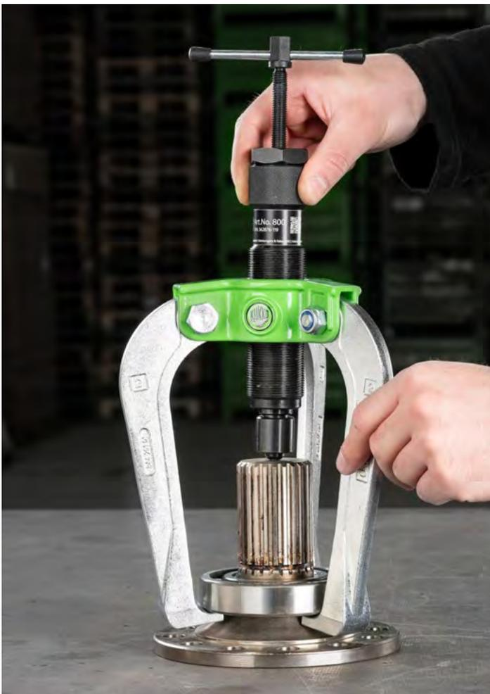
Vorspannen des Abziehers durch einschrauben der Hydraulikspindel an der Rändelung
