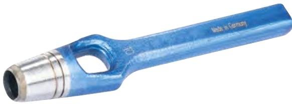
Die Henkellocheisen werden zum Lochen oder Herstellen von Dichtungen und Dichtungsringen aus Gummi, Leder, Filz, Kunststoff, Kork sowie verschiedenen Stoffen eingesetzt. Der kurze Hohlzylinder ist am unteren Rand scharf zugeschnitten. Der konische Stanzkopf ist an zwei Trägern befestigt. Dadurch entsteht eine beidseitige Ausnehmung. Dank der besonders kräftigen Ausführung der Henkellocheisen können unterschiedlichste Materialien bearbeitet werden.
