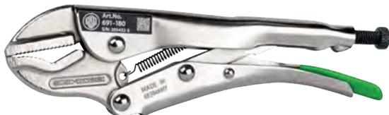
Die Ideal-Gripzangen der Baureihe 692 werden zum sicheren Festhalten von Rund-, Profil- und Flachmaterial in Werkstatt, Industrie und Handwerk genutzt. Die Gripzangen sind nicht nur handlich und können einhändig bedient werden, durch die Kniehebel-Mechanik lassen sich zudem sehr hohe Kräfte aufbringen. Die Baureihe 692 besitzt eine kombinierte Maulform mit Vierpunktauflage.
