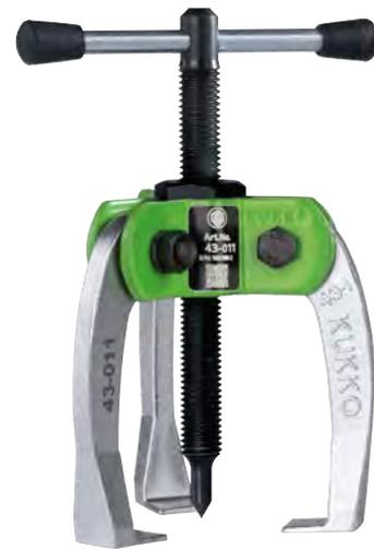
Der handliche, 3-armige Kleinteile-Abzieher der Baureihe 43-1 verfügt über die gleichen Eigenschaften wie die Baureihe 43. Hinzukommt die 3-Armigkeit, die für eine gleichmäßigere Kraftverteilung und größere Abziehkräfte sorgt.
