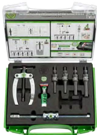
Der 6-teilige Kugellager-Auszieh-Satz mit Gegenstütze und Gleithammer K-22-B-E wird zum Ausziehen plan aufliegender Lager, Lageraußenringe und Buchsen in Handwerk, Werkstatt und Industrie eingesetzt. Die segmentierte Ausführung mit extra feinen Greifkanten erlaubt das sichere Ausziehen plan aufliegender Teile. Die beigelegte Gegenstütze oder der Gleithammer werden je nachdem, ob eine ausreichende Abstützfläche vorhanden ist, gemeinsam mit den Innenausziehern genutzt.
