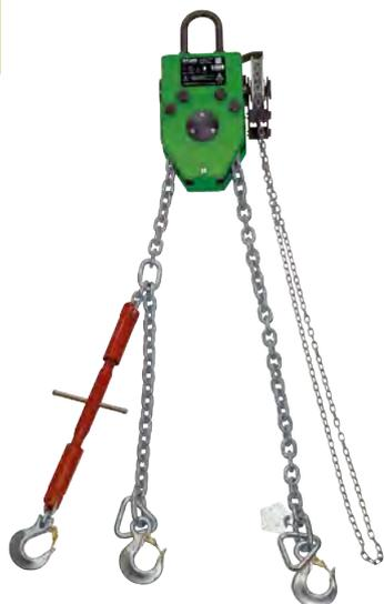
Der Motordirigent „URANOS“ wird zum Dirigieren der Schräglage beim Aus- und Einbau von Motoren, Getrieben und Batterien aller Art in Industrie und Werkstatt eingesetzt. Durch Betätigung der Handkette kann der Motordirigent universell und einfach justiert werden, um ein reibungsloses Arbeiten am Motor zu gewährleisten. Das selbsthemmende Schneckengetriebe und die 3-Punkt-Aufhängung sorgen dabei für die nötige Stabilität und Sicherheit.
