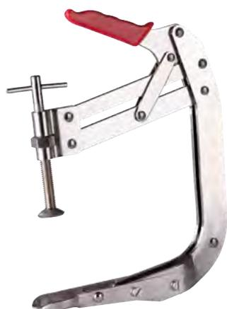
Die Ventilsfeder-Spannapparate der Baureihe 103 werden zum beschädigungsfreien Ein- und Ausbau von Ventilen für kopfgesteuerte Motoren in der Automotive genutzt. Die Spannapparate ermöglichen einen sicheren Ausbau von Ventilen, indem die Ventilsfeder gespannt wird.
