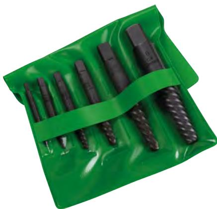
Der Schraubenausdreher-Satz mit breit gerillter Form wird zum Ausdrehen von abgebrochenen Bolzen und Schrauben mit Rechtsgewinde eingesetzt. Die Schraubenausdreher sind ein unentbehrliches Werkzeug, auf das weder Hobbyschrauber noch Handwerkerprofi verzichten kann. Im Set enthalten sind Schraubenausdreher für Gewindedurchmesser von 3 bis 24 mm.
