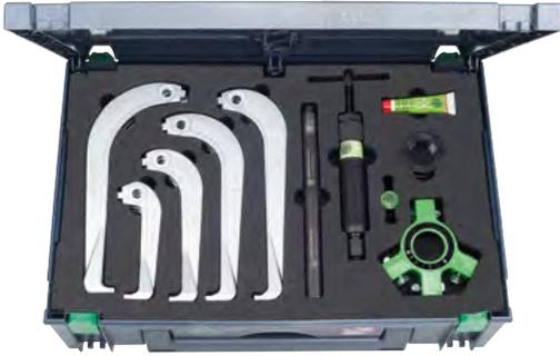
Der 21-teilige, hydraulische „10 Abzieher“-Satz mit selbstzentrierenden Abzugshaken wird zum Abziehen von Lagern, Zahnrädern, Scheiben etc. in Handwerk, Industrie und Werkstatt genutzt. Im Set enthalten sind Abzieher, Hydraulikspindel, Haken, sowie 2- und 3-armige Kombi-Traversen, die durch die leicht austauschbaren, vielfach kombinierbaren Einzelteilen zu zehn verschiedenen Abziehern kombiniert werden können.
