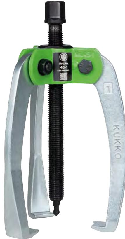
Die robusten, 3-armigen Industrie-Abzieher der Baureihe 45 weisen die gleiche Funktionalität auf wie die Baureihe 44. Der Unterschied liegt in der 3-Armigkeit, wodurch eine gleichmäßigere Kraftverteilung und größere Abziehkräfte erzielt werden.
