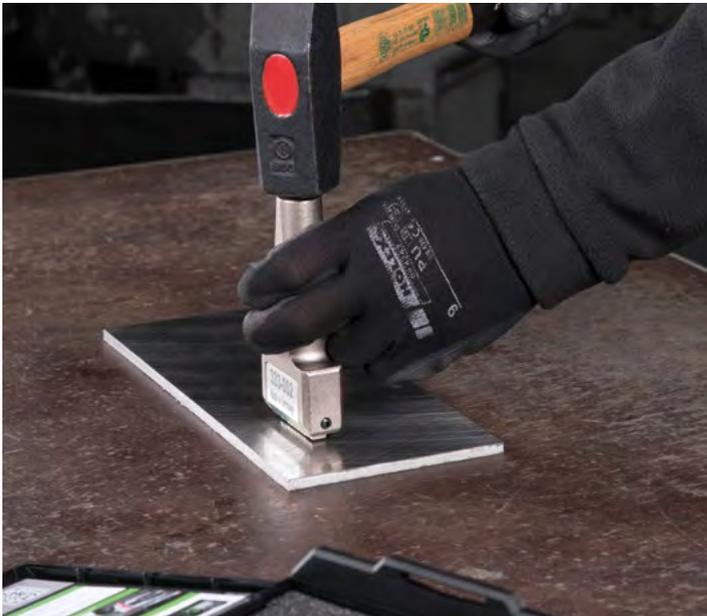
Markieren einer Stahlplatte mit einem Schlagstempel der Baureihe 333
