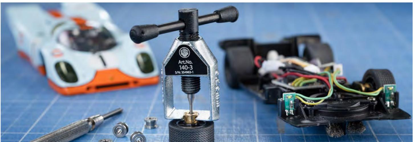
Abziehen eines Kugellagers an einem Modellautoreifen mit dem 140-3
