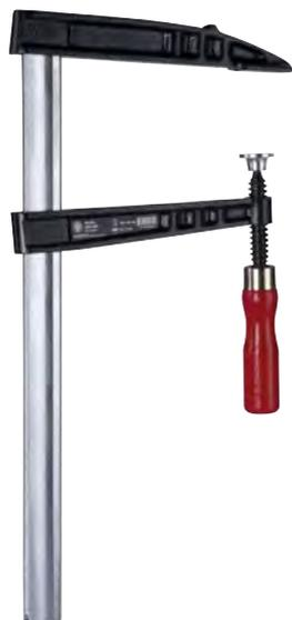
Die Tiefspann-Temperguss-Schraubzwingen mit Holzgriff der Baureihe 505 bis 509 werden zum Zusammenpressen und Festhalten großer Werkstücke im Bau und in der Industrie genutzt. Durch die Gleitschiene aus Stahl lässt sich eine hohe Spannkraft erreichen. Die Baureihen 505 bis 509 sind mit ihrem runden Holzgriff Klassiker des Schraubzwingensortiments.
