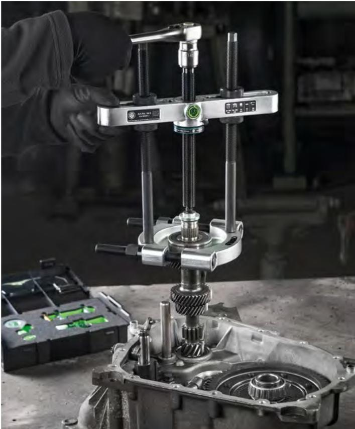
Abziehen eines Lagers von einer Getriebewelle
