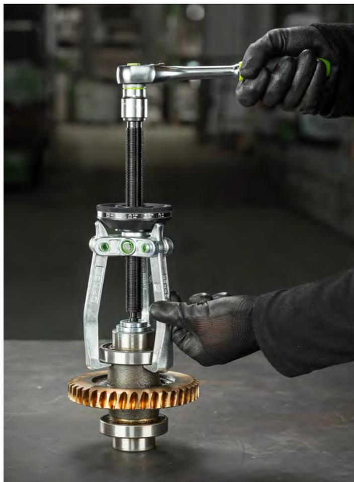
Außenabziehen eines Kugellagers von einer Getriebewelle
