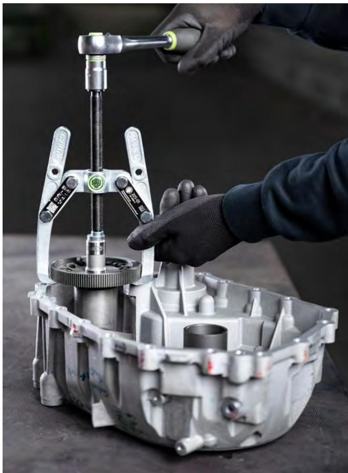
Ausbau eines Getriebezahnrades mit dem 205-01
