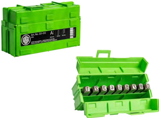
Der 9-teilige Standard-Schlagzahlensatz der Baureihe 328 wird zur problemlosen Kennzeichnung von Werkstücken mit einer Festigkeit von bis zu 900 N/mm<sup>2</sup> (27 HRC) in Handwerk, Industrie und Werkstatt genutzt. Der Satz besitzt ein genormtes Schriftbild nach DIN 1451 und eine Härte an der Gravur zwischen 58 und 61 HRC. Der Standard-Satz der Baureihe 328 ist ein Klassiker, der für eine universelle Anwendung ideal geeignet ist.
