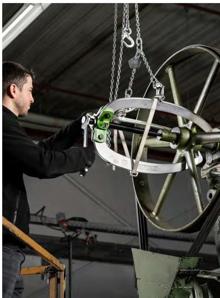
Ein zusätzlicher Spanngurt fixiert die Abziehschenkel
