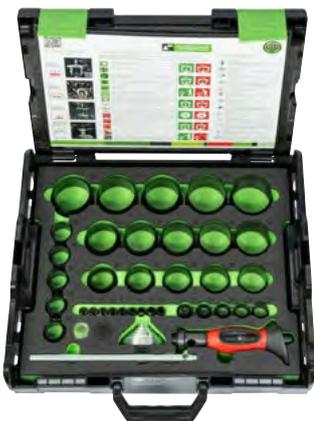
Der 38-teilige Ringstanzwerkzeug-Satz wird zum Lochen oder Herstellen von Dichtungen und Dichtungsringen aus Gummi, Leder, Filz, Kunststoff, Kork sowie Stoffen eingesetzt. Dank der doppelten Aufnahme lassen sich Dichtungsringe in nur einem Arbeitsgang herstellen, indem gleichzeitig zwei Stanzmesser mit unterschiedlichem Durchmesser am Stanzeisenhalter befestigt werden. Die Stanzmesser sind besonders scharf zugeschnitten. Dies ermöglicht die Bearbeitung unterschiedlichster Materialien.
