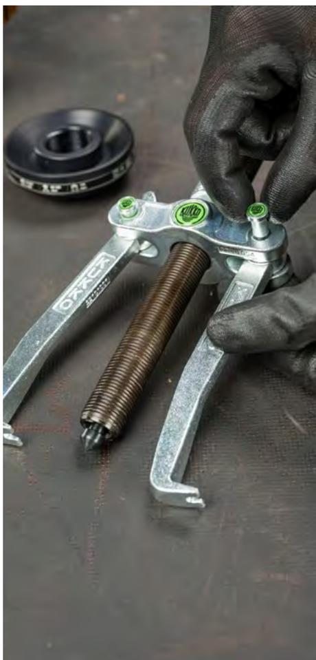
Einsetzen der Steckbolzen
