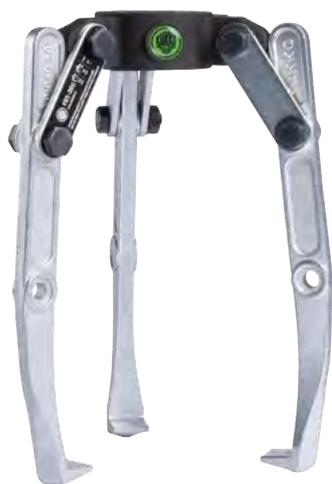
Die 3-armigen Kombi-Abzieher mit schwenkbaren Abzugshaken der Baureihe Y-208 werden zum Abziehen von besonders großen und fest-sitzenden Lagern, Zahnrädern, Scheiben etc. in Handwerk, Industrie und Werkstatt genutzt. Kombi-Abzieher können sowohl 3-armig wie 2-armig verwendet werden. Zur Anwendung wird noch ein Hydraulischer Druckzylinder mit Kragengwinde der Baureihe YRE benötigt.
