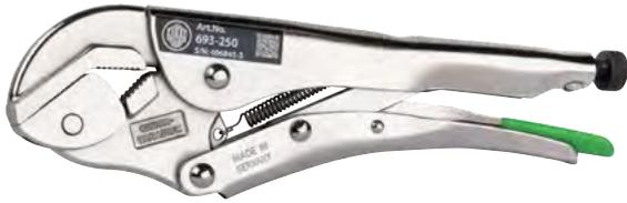
Die Parallel-Plus-Gripzangen der Baureihe 693 werden zum sicheren Festhalten von Rund-, Profil- und Flachmaterial in Werkstatt, Industrie und Handwerk genutzt. Die Gripzangen sind nicht nur handlich und können einhändig bedient werden, durch die Kniehebel-Mechanik lassen sich zudem sehr hohe Kräfte aufbringen. Die Baureihe 693 besitzt eine kombinierte Maulform mit einer schwenkbaren Backe, wodurch paralleles und prismatisches Spannen möglich wird.
