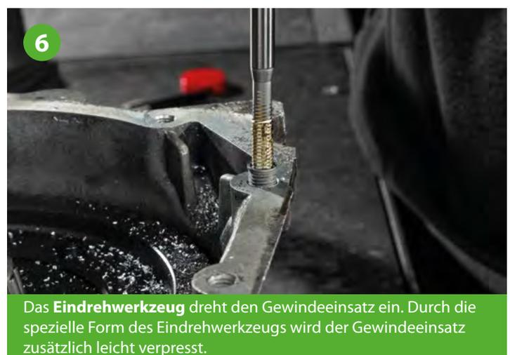
Das **Eindrehwerkzeug** dreht den Gewindeeinsatz ein. Durch die spezielle Form des Eindrehwerkzeugs wird der Gewindeeinsatz zusätzlich leicht verpresst.
