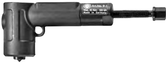
Die hydraulische Zusatzpresse dient der Erhöhung der Druckleistung mechanischer Abziehvorrichtungen bei besonders festsitzenden Lagern, Zahnrädern und Scheiben. Mit Hilfe der hydraulischen Zusatzpresse lassen sich Abziehkraft von bis zu 30 t erzielen.
