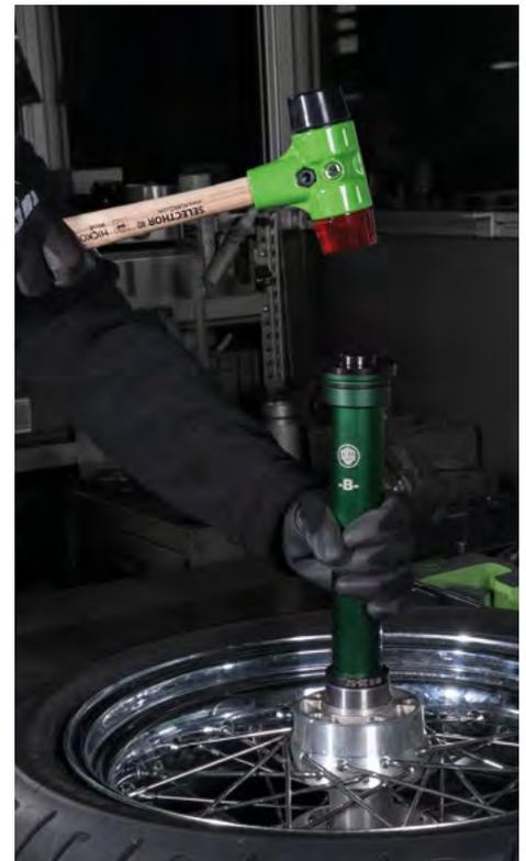
Kugellagereinbau mit dem 71-L
