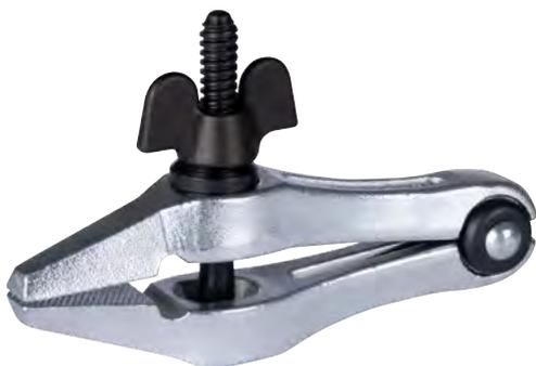
Der Spitzfeilkloben mit spitzem Maul und Flügelmutter der Baureihe 102 wird zum besonders festen Greifen von Werkstücken auf kleiner Fläche in Werkstatt, Industrie und Handwerk genutzt. Die Backeninnenseite ist dabei mit einem prismatischen Einschnitt geriffelt, sodass runde und kantige Teile gespannt werden können. Die Baureihe 102 überzeugt durch ihre Handlichkeit, die ein Drehen und Wenden des Werkstücks beim Arbeiten ermöglicht.
