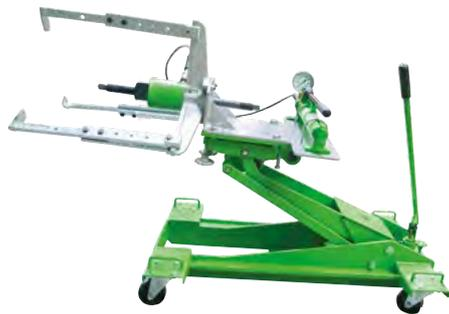
Der hydraulische, mobile 3-armige Abzieher mit verstellbarer Spanntiefe "DAVID" wird zum Abziehen von großen Lagern, Zahnrädern und ähnlichen Bauteilen in Schwerindustrie, Handwerk und Werkstatt genutzt. Mit einer maximalen Belastung von 20 t bietet der Abzieher eine starke, hydraulische Lösung für sonst schwer zu bewältigende Aufgaben beim Abziehen von großen Teilen. Die Abzugshaken sind in der Länge verstellbar und können der benötigten Spanntiefe angepasst werden.
