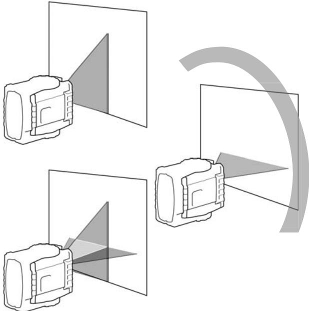
В случае большого наклона лазер начинает мигать.
