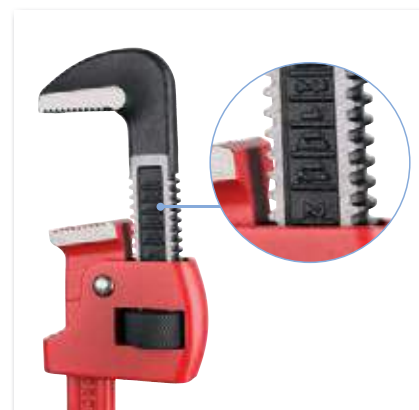
Деления шкалы на верхнем крюке показывают размер зева ключа для захвата труб различного размера
