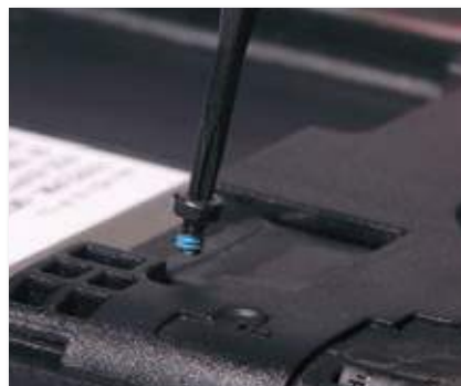
Закалённый магнитный наконечник, обеспечивающий отличное удержание головки винта
