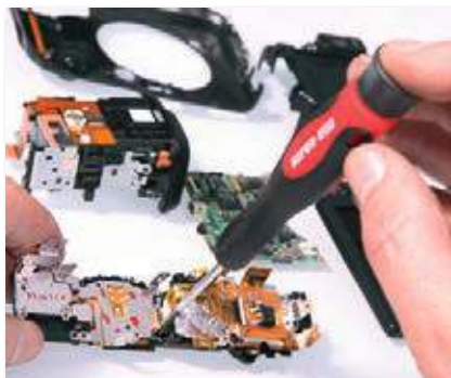
Точные отвёртки для работы с электронными частями, компьютерной техникой, часовыми механизмами
