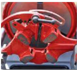
Автоматическая резьбонарезная головка 1/2 – 2"
