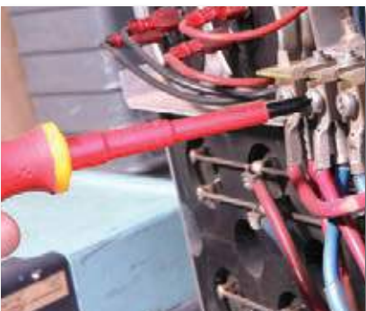
Безопасные отвёртки для электрических работ
