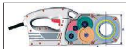
Единственный на рынке резьбонарезной клупп с геликоидальной трансмиссией
