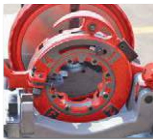
Автоматическая резьбонарезная головка 2.1/2 – 4"
