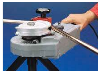
Благодаря использованию дополнительной треноги, ROBEND® 4000 можно использовать на необходимой рабочей высоте
