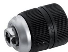
Трехлапчатый патрон применяется для зажима инструмента (сверл, буров, концевых фрез и т.п.) с цилиндрическим, трех- и шестигранным хвостовиком во всех видах дрелей: электрических, аккумуляторных, ручных. Предназначен для использования с ударной дрелью (< 900 Вт) и шурупвертами <= 18 В.
