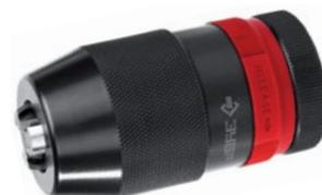
Трехлапчатый патрон применяется для зажима инструмента (сверл, концевых фрез и т.п.) с цилиндрическим, трех- и шестигранным хвостовиком во всех видах сверлильных станков с посадкой на конус Морзе (шпиндель В16)
