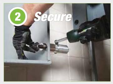
**Secure SPEED LOCK onto draw stud:**
