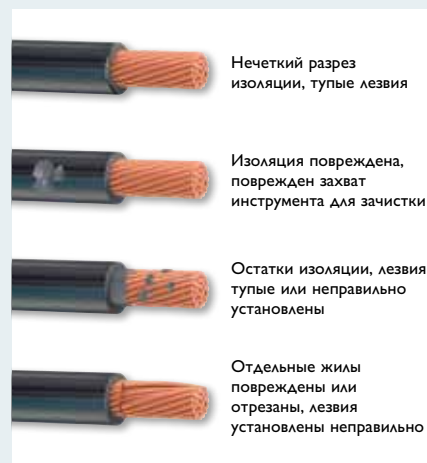
Зачистка не соответствует DIN МЭК 60352-2
