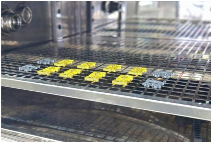
Циклические температурные испытания клемм на DIN-рейку
