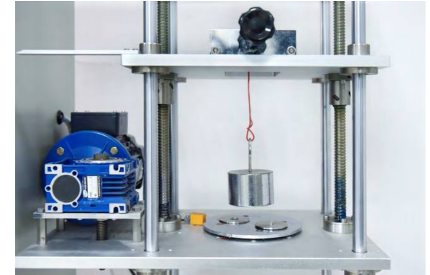
Испытание клемм на отрыв в зафиксированном положении
