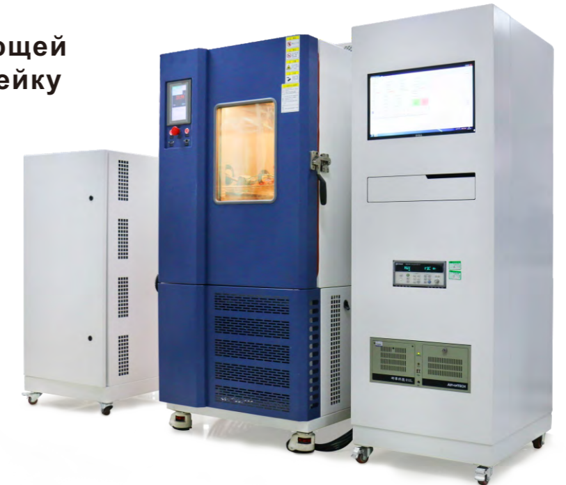
Испытательное оборудование для тестирования пружинных клемм на старение
