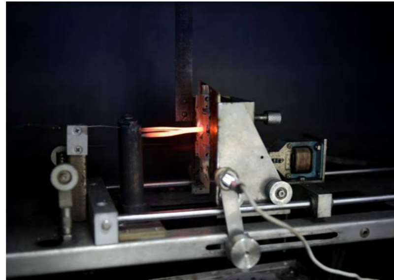
Испытание нитью накала клемм на DIN-рейку
