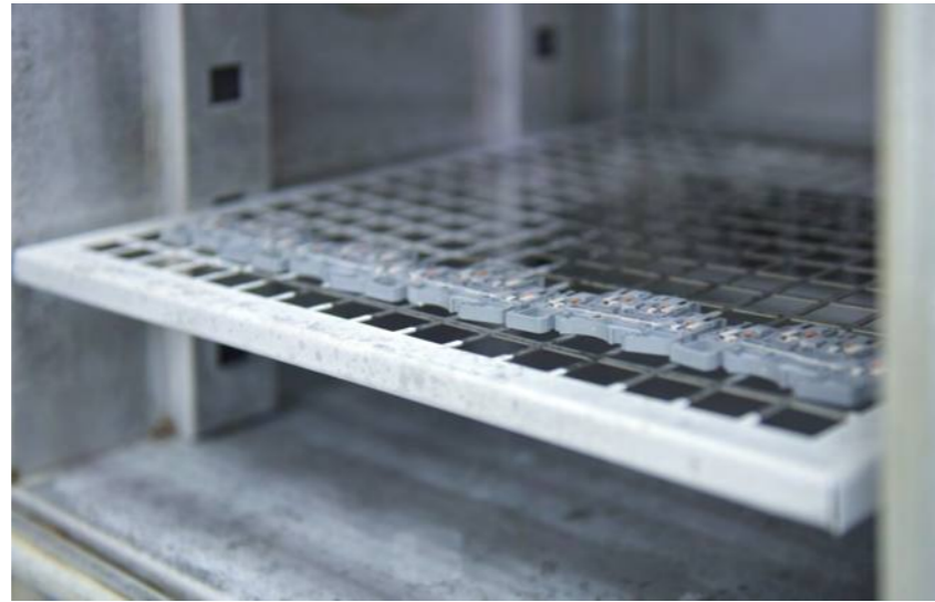
Циклические температурные испытания клемм на DIN-рейку
