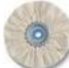
ПОЛИРОВАЛЬНЫЕ КОЛЬЦА, СУКНО, ЖЕСТКИЙ 15 мм ширина, отверстие 14 мм, для (предварительного) полирования цветных металлов, железа/стали и легированной стали, полировальная паста
