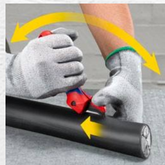
Функция храповика позволяет производить зачистку с большим комфортом и меньшими усилиями
