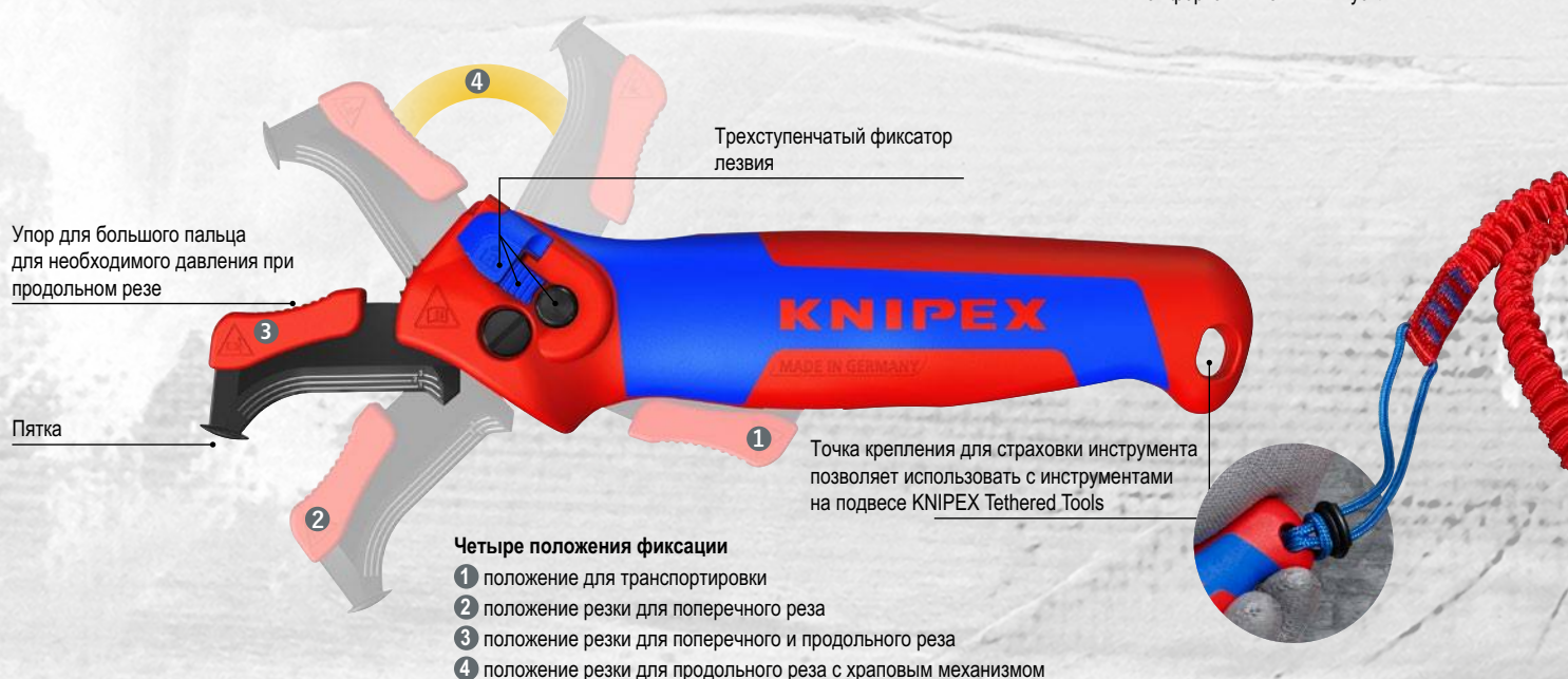
Функция храповика позволяет производить зачистку с большим комфортом и меньшими усилиями
