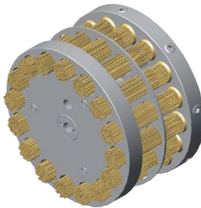
Schematische Darstellung eines Bürstkopfes für Entgratpinself
