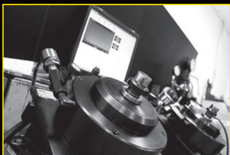
Компьютерный диагностический стенд: измерение силы удара пневматических инструментов
