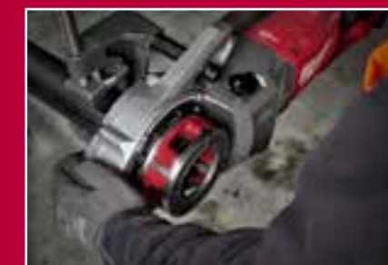
Боковая рукоятка позволяет избежать контакта с вращающимися элементами до и во время нарезания резьбы.
