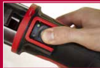
FORCE LOGIC™ индикатор обжима
