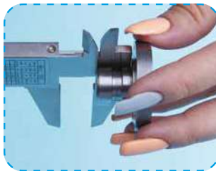
Измерение расстояний между выступами (по высоте)
