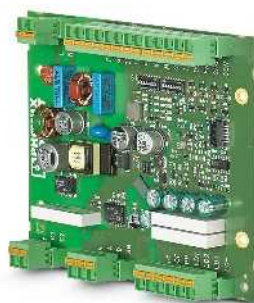
Зарядный контроллер перем. тока Basic, печатная плата, процесс зарядки В, с разъемом MSTB
