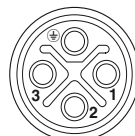
Расположение контактов гнезда M12, 3 конт.+PE, кодировка S, вид со стороны гнезда
