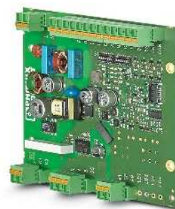
Зарядный контроллер перем. тока Basic, печатная плата, процесс зарядки С, с разъемом MSTB
