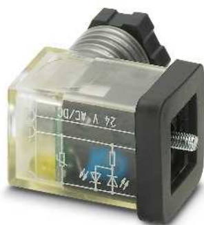
Защитная схема: варистор
