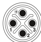
Расположение контактов штекера M12, 3 конт.+PE, кодировка S, вид со стороны штыревой части
