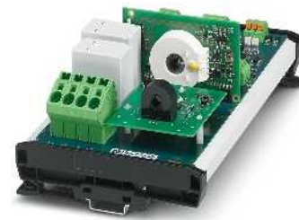
Зарядный контроллер перем. тока Basic NAR, корпус для монтажной рейки, процесс зарядки C, уровень 2
