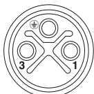
Расположение контактов гнезда M12, 2 конт.+PE, кодировка S, вид со стороны гнезда
