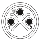
Расположение контактов штекера M12, 2 конт.+PE, кодировка S, вид со стороны штыревой части
