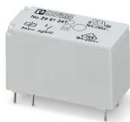
Реле с 1 замыкающим контактом для повышенного тока включения, макс. 130 А peak
