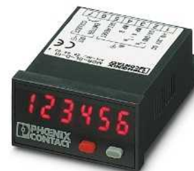
Программируемый индикатор для отображения частоты, длительности импульсов и времени
