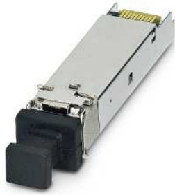
Стекловолоконно, гигабитная дальность передачи до 80 км
