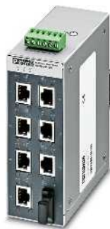
7 портов RJ45 и 1 оптический порт
