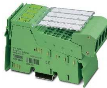
8 входов, с питанием датчика иницирующих сигналов
