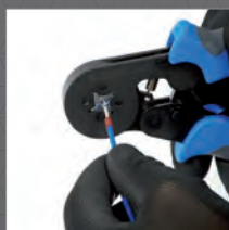
Высококотная геометрия губок обеспечивает крепкий захват обжимного кольца.
