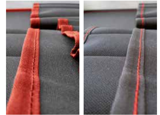
farbige Randeinfassung / Nähte coloured piping / seams
