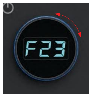
Регулировка температуры вращением поворотной нажимной кнопки.
