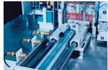
Датчик переключается при достижении магнитом порога точки переключения. Например, тип M18 обнаруживает диапазон до 70 мм.
