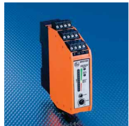
Блок оценочной электроники для установки в шкаф управления.
