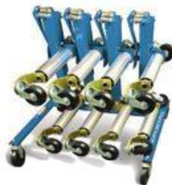
Пример хранения 4-х домкратов N3S2 на стенде.
