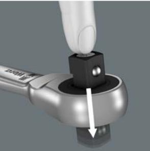
Завинчивание обычно ведется в одну сторону. При использовании трещотки может произойти непроизвольное переключение реверса. Несъемный сдвижной квадрат с надежной фиксацией насадок предотвращает такое нежелательное изменение вращения.
