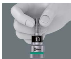
Фиксация шестигранного винта в торцовой головке обеспечивается двумя шариковыми фиксаторами и высокопрочным эластичным воротником. От механического повреждения его защищает стальной буртик, расположенный спереди. Они особенно помогают при работе в труднодоступном месте, куда для поддержки винта не помещается вторая рука.
