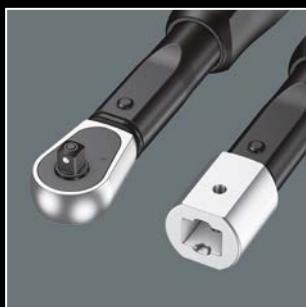
Динамометрические ключи Click-Torque – это трещотки с реверсом (привод  $\frac{1}{4}$ ",  $\frac{3}{8}$ ",  $\frac{1}{2}$ " и  $\frac{3}{4}$ ") или с посадочным гнездом для сменных инструментов (9×12 мм, 14×18мм) с моментом силы от 2,5 Нм до 1000 Нм.
