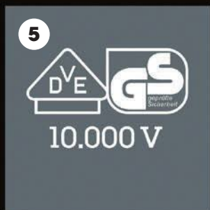
5 Поштучная проверка инструментов по стандарту IEC 60900 под напряжением 10000 вольт
