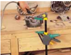
просто выполняемое переоборудование для функции распора
