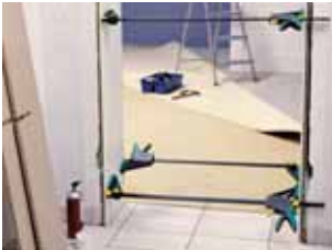
просто выполняемое переоборудование для функции распора
