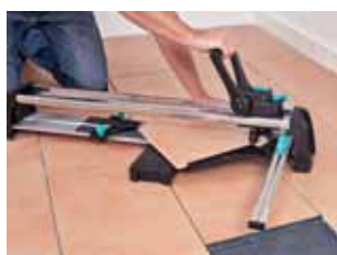
специальная направляющая для диагональных разрезов
