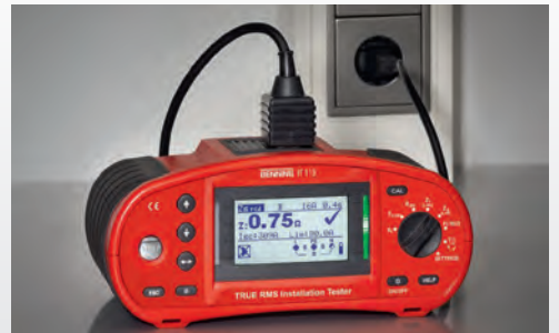
IT 115 bei der Schleifenimpedanzmessung ohne RCD-Auslösung
