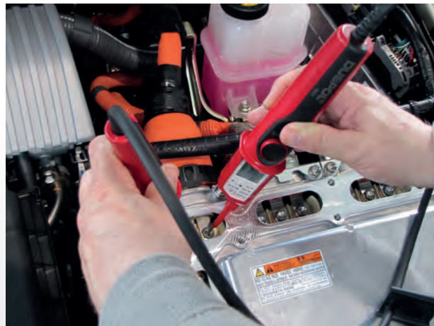
Prüfung der hohen DC-Spannung eines HV-Elektrofahrzeuges
