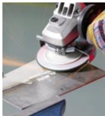
Удаление и чистовая обработка сварного шва на нержавеющей стали
