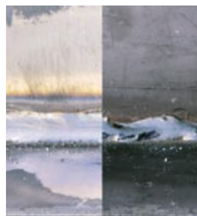
Очищение поверхностей перед сваркой от окалины приводит к очень чистым сварным швам (см. рис. слева).
