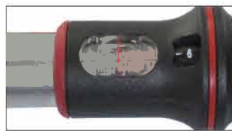
• Двойная шкала с делениями Н-м и LB/FT (фунто-фут). Дополнительная шкала на 10 делений выбирается путем вращения рукоятки.
