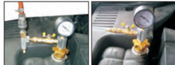
вакуумная откачка воздуха замена жидкости в радиаторе
