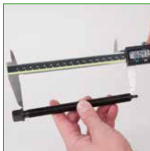
b Измерить длину резьбы до наконечника шпинделя.
