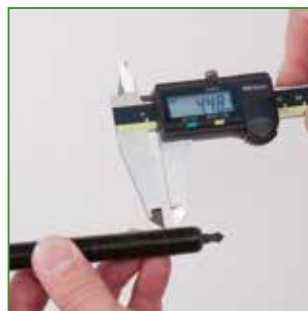
c Измерить длину сверх трех витков резьбы.
