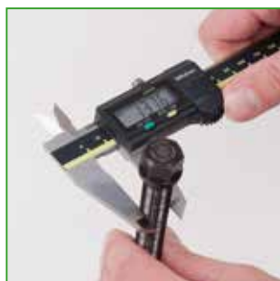
a Измерить диаметр шпинделя
