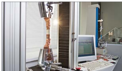
Испытания наконечников на разрывное усилие
