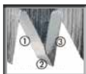
Тройная заточка зубьев teeth with triple grinding denture à 3 faces afilado dentado triple
