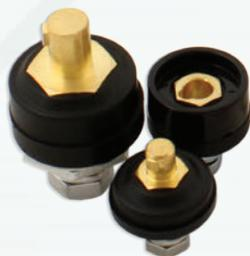
Вставки и гнезда предназначены для моментального соединения сварочных кабелей и источника питания. Вставки и разъемы могут использоваться для удлинения сварочных кабелей, отличаются номинальной мощностью, изготавливаются как правило из латуни с резиновой изоляцией под кабеля с различным сечением.
