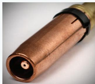
Сопло надежно фиксируется на гусাকে и обеспечивает тепловод.
