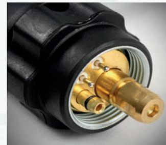
Евроразъём позволяет быстро и легко подключать горелку к механизму подачи проволоки.
