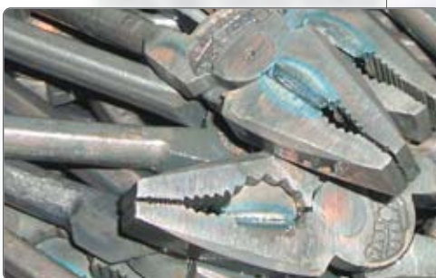
Induktiv gehärtete Schneiden Cutting edges induction hardened
