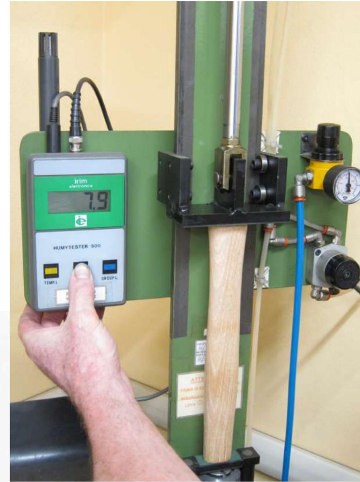
PROVA DI ESTRAZIONE *EXTRACTION TEST*
