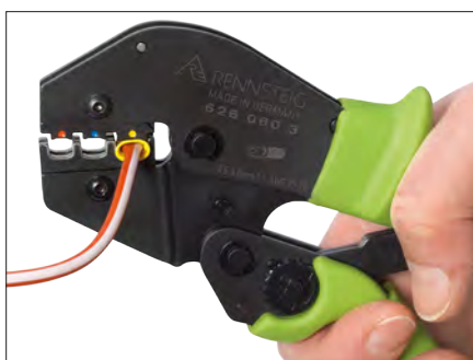
Эффективный обжим (работа одной или обеими руками) Powerful crimping (one- or two-handed)
