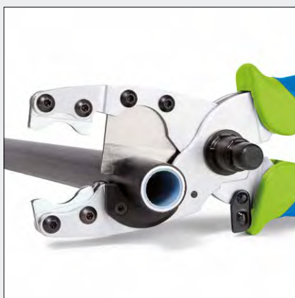
Schneiden von Aluminium-Verbundrohr
