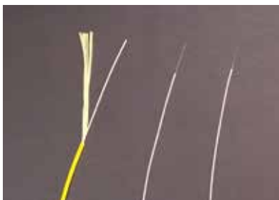
Оболочка 900 Микрон 250 Микрон Три степени зачистки оптоволоконна
