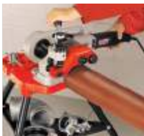
Применение устройства для накатки желобков ROGROOVER
