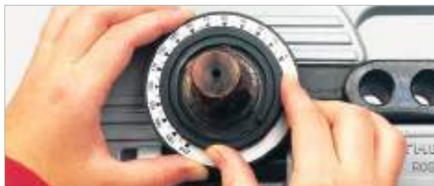
Предварительная настройка угла гибки без использования инструмента
