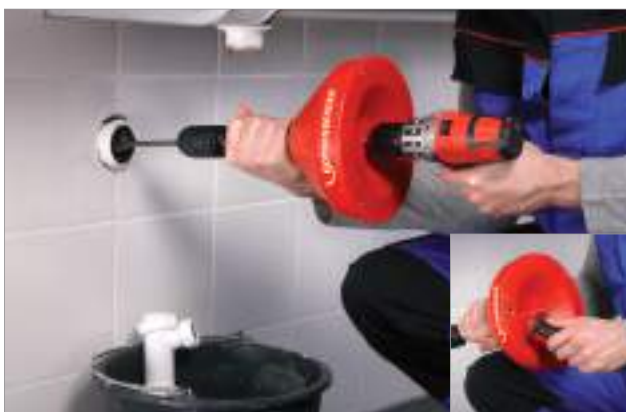
Привод от аккумуляторной дрели
