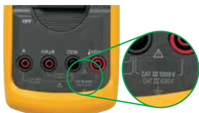
Используйте измерительные приборы со следующей маркировкой: 1000 В категории III или 600 В категории IV
