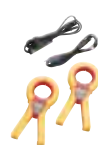
ES-1625 Набор зажимов для измерений в выборочном и безэлектродном режимах для модели 1625
