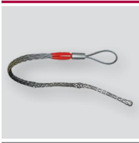
Предназначен для надежного захвата неизолированных алюминиевых и сталеалюминиевых проводов (ГОСТ 839-80), грозозащитных тросов, в том числе со встроенным оптическим кабелем ОК, определенного диаметра и соединения их с трос-лидером при проведении монтажных работ «под тяжением» на линиях ВЛ.
