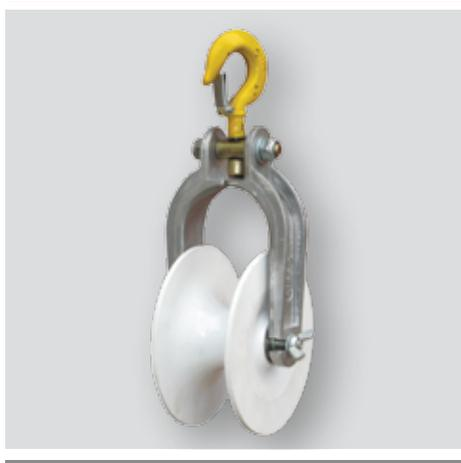
Предназначен для проведения монтажных работ по раскатке самонесущих изолированных проводов (СИП), а так же самонесущих оптических кабелей (ОКСН) на линиях ВЛ напряжением 0,4-10 кВ. Ролик РТ-2 применяется на промежуточных опорах. Подвес ролика осуществляется за арматуру крепления СИП при помощи крюка.
