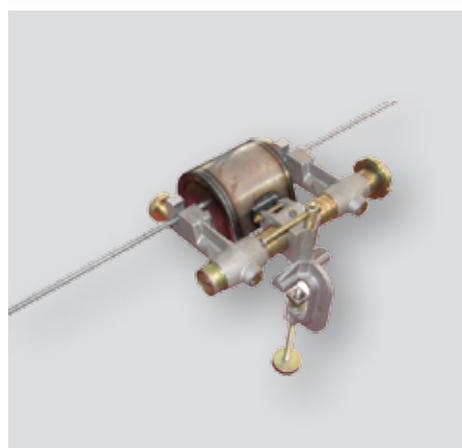
Предназначено для соединения неизолированных проводов марок А и АС (ГОСТ 839-80) методом сварки с использованием термодатронов марки ПА и ПАС в петлях (шлейфах) при строительстве и ремонте линий ВЛ.
