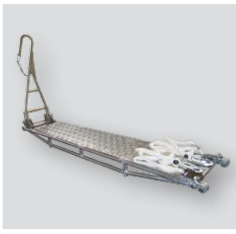
Предназначены для размещения на нем не более двух электромонтеров при проведении ремонтных работ на натяжных гирляндах изоляторов ВЛ напряжением 110÷500 кВ. Трап длиной более 3 метров для удобства транспортирования и хранения выполнен разъемным и состоит из двух полутрапов. В рабочем положении полутрапы соединяются между собой фиксирующими пальцами.
