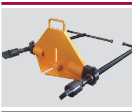
Предназначена для стягивания гирлянды при замене изоляторов и восприятия на время ремонта веса фазы проводов. Балка Б-500 специально разработана для опор марки ПБ-500-5н и ПБ-330-7н часто встречающихся на линиях ВЛ напряжением 330-500кВ.
