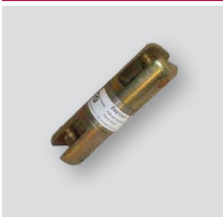
Предназначен для компенсации момента скручивания возникающего в проводах и кабелях в процессе проведения монтажных работ «под тяжением». Вертлюг ВМ-15 используется совместно с монтажными чулками и является соединительным звеном между проводом и трос-лидером.
