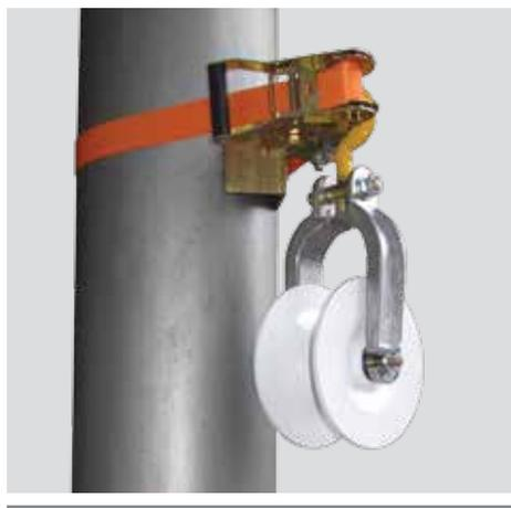
Предназначен для проведения монтажных работ по раскатке самонесущих изолированных проводов (СИП), а так же самонесущих оптических кабелей (ОКСН) на линиях ВЛ напряжением 0,4-10 кВ. Ролик РТ-2-1 применяется на промежуточных опорах. Крепление ролика осуществляется в любом удобном месте опоры при помощи ремня с храповым механизмом.
