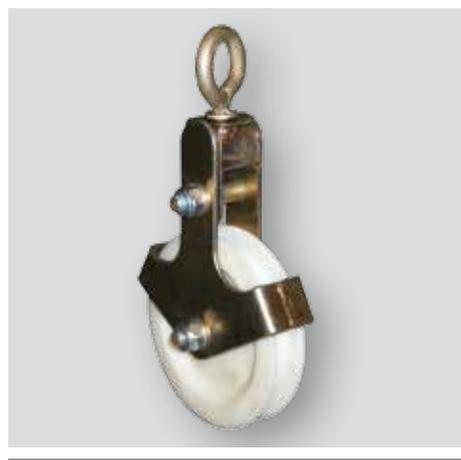
Предназначен для перепуска синтетического каната при выполнении монтажно-такелажных работ на линиях, находящихся под напряжением. За счет своего малого веса, блок БИ-4 используется монтажниками для подъема и спуска инструмента в процессе выполнения работ на высоте.
