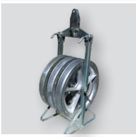
Предназначены для одновременной раскатки 2 или 3 проводов расщеплённой фазы при монтаже ВЛ напряжением 330-500 кВ.
