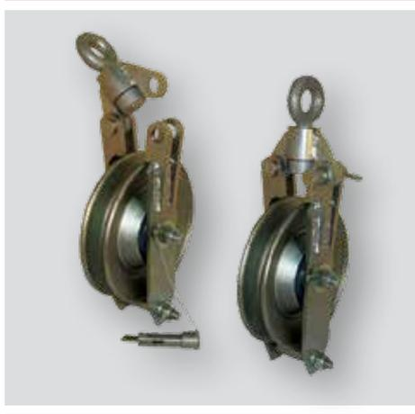
Предназначен для работы со стальным канатом при выполнении специальных монтажных, такелажных работ, при строительстве, реконструкции и ремонте воздушных линий электропередачи и других объектов. Так же отводной блок может использоваться для изменения направления движения каната или изменения направления передаваемого по канату тягового усилия.
