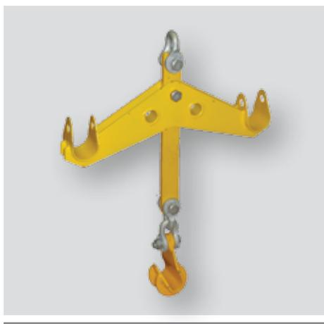
Предназначен для восприятия веса проводов путем одновременного подхвата за один, два и три провода расщепленной фазы при выполнении ремонтных работ на поддерживающих гирляндах изоляторов. Подхват П-ЗП используется совместно с балками: Б-500 БРП-50 БР-50. При сочленении подхвата с балками при помощи полимерных изоляторов, работы могут производиться «под напряжением».
