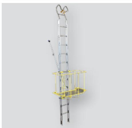
Предназначена для подвесных работ на опорах ЛЭП. Подвес лестницы осуществляется при помощи подвесных крюков жестко закрепленные с одной стороны лестницы. Для удобства выполнения работ на высоте, лестница комплектуется съёмной навесной площадкой, которая легко может перемещаться по высоте лестницы с шагом 450 мм.
