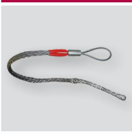
Предназначен для надежного захвата неизолированных алюминиевых и сталеалюминиевых проводов (ГОСТ 839-80), грозозащитных тросов, в том числе, со встроенным оптическим кабелем, определенного диаметра и соединения их с трос-лидером при проведении монтажных работ «под тяжением» на воздушных линиях ВЛ.
