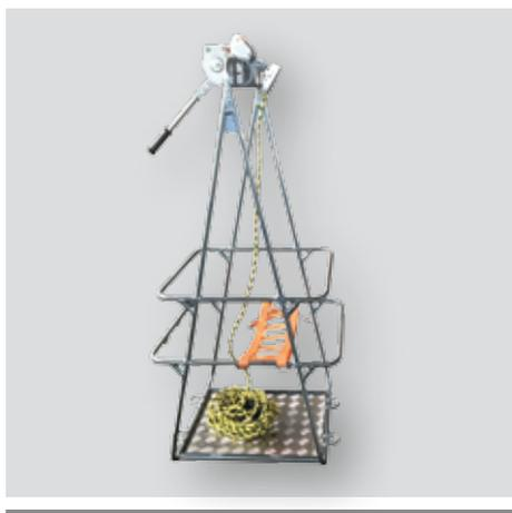
Предназначено для размещения электромонтера в устройстве при осмотре гирлянд и замене дефектных изоляторов, при замене сцепной арматуры поддерживающих гирлянд на линиях ВЛ напряжением 110÷750 кВ. Устройство так же может быть использовано для доставки монтера к проводу методом «маятника».
