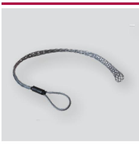
Предназначен для надежного временного захвата электрического кабеля определенного диаметра при его прокладке. Кабельный чулок представляет из себя плетеную специальным образом с определенным шагом из оцинкованного стального каната конструкцию в виде чулка с одной гибкой петлей в его изголовье. Данная конструкция чулка позволяет схватывать и надежно удерживать кабель под воздействием нагрузки без повреждения изоляции.
