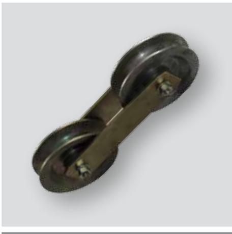
Предназначен для работы со стальным канатом при регулировке стрел провеса одновременно 2-х и 3-х проводов на воздушных линиях электропередач. Схема для одновременного натяжения трех проводов приведена ниже. Использование подобных схем при регулировке стрелы провеса проводов позволяет значительно сократить время монтажа.
