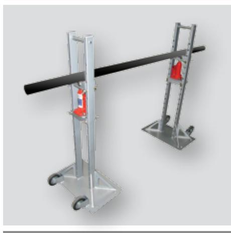
Предназначен для подъема кабельных барабанов и удержания их на весу во время размотки кабеля с барабана. Кабельный домкрат типа ДК-ГП применяется в качестве отдающего устройства при перематке и прокладке кабеля. Применение данного домкрата на строительной площадке или в производственном цехе, значительно ускоряет процесс монтажа кабельных линий, за счет скорости его установки и удобства эксплуатации.
