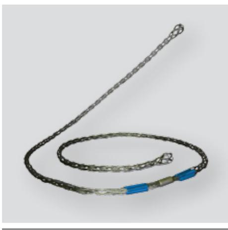
Предназначен для быстрого и надежного временного соединения неизолированных алюминиевых и сталеалюминиевых проводов (ГОСТ 839-80), грозозащитного троса, в том числе, со встроенным оптическим кабелем, определенного диаметра, а также соединения проводов и тросов с трос-лидером при проведении монтажных работ «под тяжением» на воздушных линиях ВЛ.
