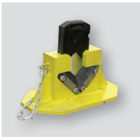
Предназначен для рубки алюминиевых, сталеалюминиевых и медных проводов ГОСТ 839-80, а так же стальных канатов при выполнении монтажных работ на линиях ВЛ путём удара кувалдой по подвижному ножу..
