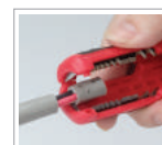
Stripping low volt cable
