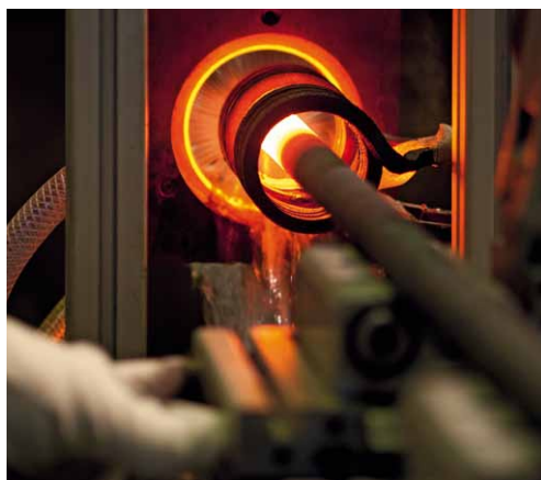
Индуктивная закалка зубил Inductive tempering
